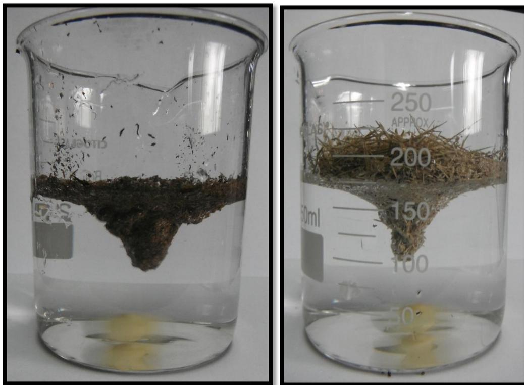
**Figura N° 19** – Comportamiento de los sorbentes en el agua bajo agitación. Sorbente comercial (izquierda) y Bagacillo (derecha).
