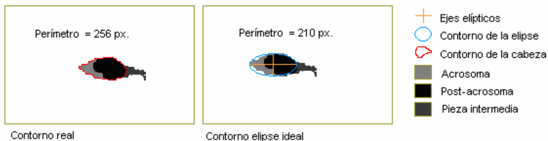
Figura 23: Cálculo de perímetro de la cabeza y perímetro de elipse ideal
