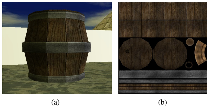
Figura 2.5: Ejemplo de una textura atlas (2.5(b)) correspondiente a un modelo 3D (2.5(a)).
