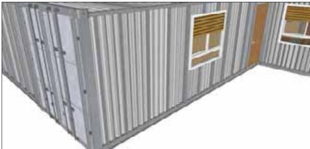
Fig. 2.67. Montaje de los elementos para fijaciones de los paneles de la fachada TEK®. Fuente y Diseño: Hernández, G.
