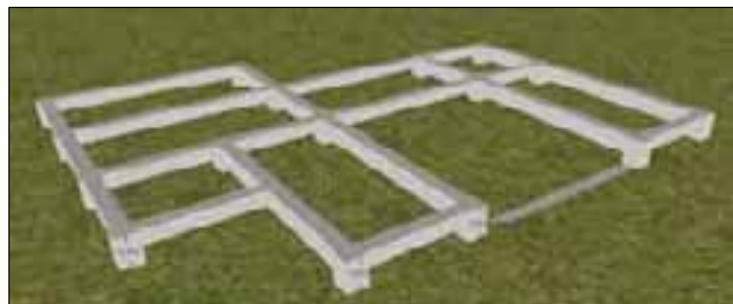
Fig. 2.18. Pedestales y vigas de riostra por encima del suelo Fuente y Diseño: Hernández, G.
