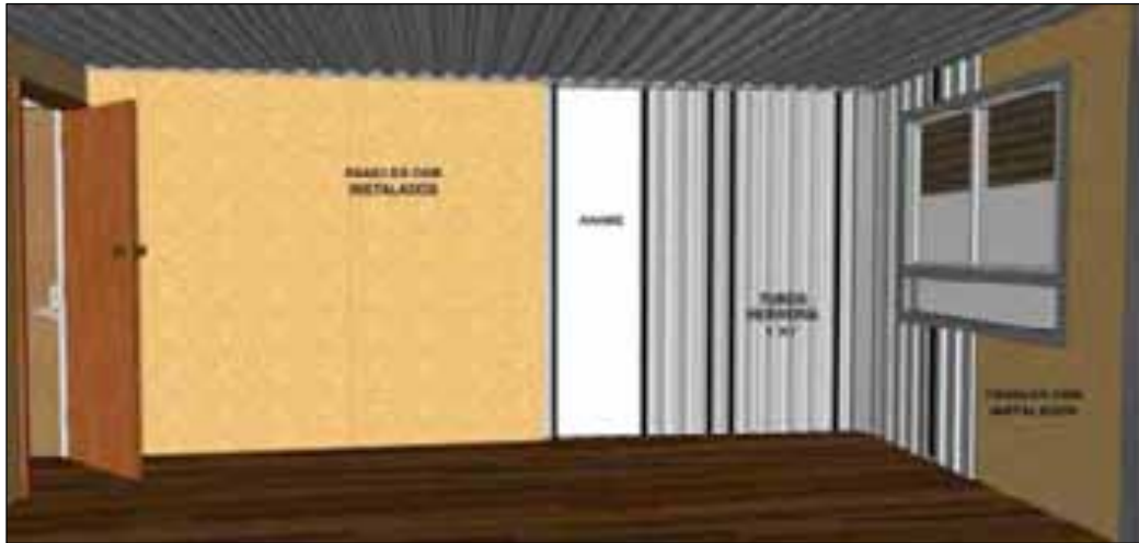
Fig. 2.62. Instalación de los paneles de anime y OSB® Fuente y Diseño: Hernández, G.
