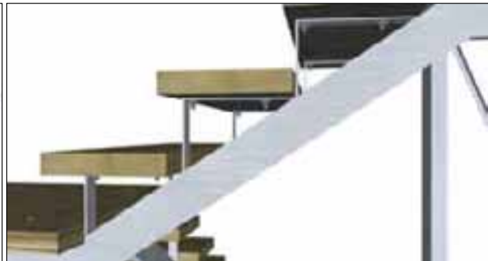
Fig. 2.33. Escalones de madera empernados a las pletinas y al perfil de descanso. Fuente y Diseño: Hernández, G.
