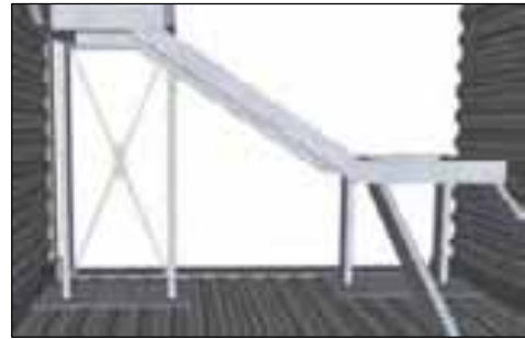
Fig. 2.31. Rigidizador para estabilizar estructura. Fuente y Diseño: Hernández.
