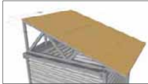
Fig. 2.43. Colocación de paneles OSB® sobre la estructura fijada. Fuente y Diseño: Hernández, G.
