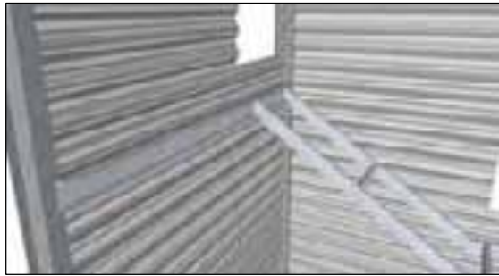
Fig. 2.30. Colocación de UPEL C 120 para apoyo a Tubulares. Fuente y Diseño: Hernández, G.
