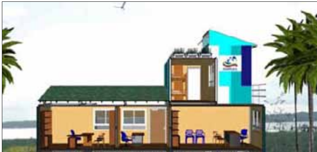
Fig. 2.10. Corte longitudinal sentido oeste-este con vista a las oficinas y una habitación. Fuente Diseño: Hernández, G.
