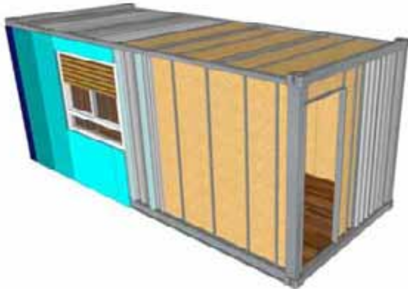
Fig. 2.64. Vista de sistemas de fijación de los paneles en paredes y techo OSB®. Fuente y Diseño: Hernández, G.
