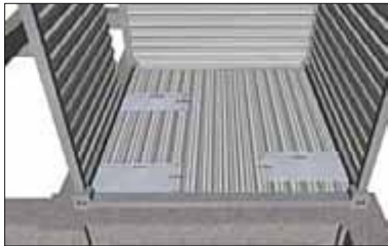
Fig. 2.28. Colocación de soportes metálicos de \frac{1}{4} " Fuente y Diseño: Hernández, G
