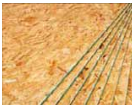
Fig. 2.61. Apariencia y composición del OSB®. Fuente: http://www.consmos.com/osb.html
