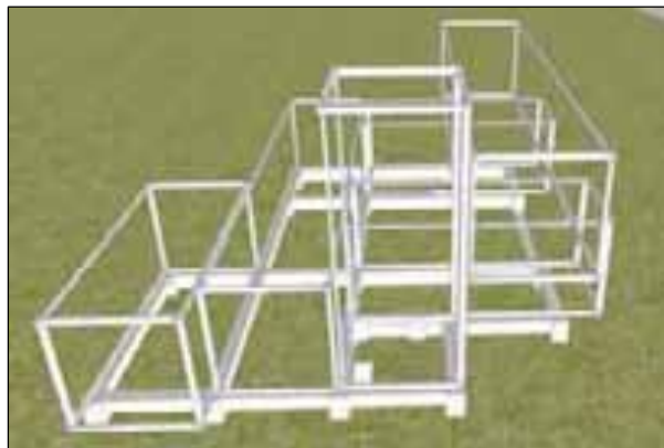
Fig. 2.19. Colocación de los contenedores sobre pedestales y vigas de riostra. Fuente y Diseño: Hernández, G
