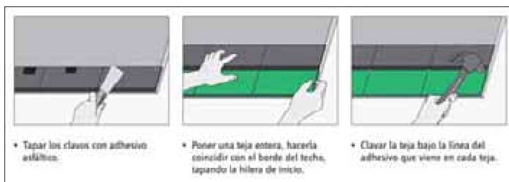
Fig. 2.51. Instalación de tejas asfálticas rectangulares.
