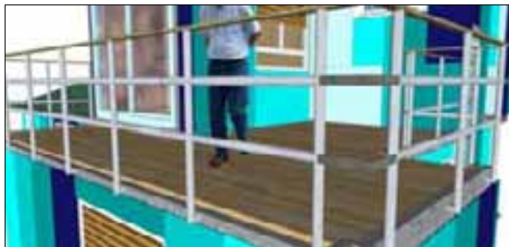
Fig. 2.59. Baranda de la terraza y Uniones con Pletinas. Fuente y Diseño. Hernández, G.
