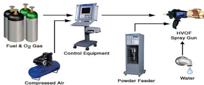
Figura 8 Proceso de Termo-Rociado vía HVOF
