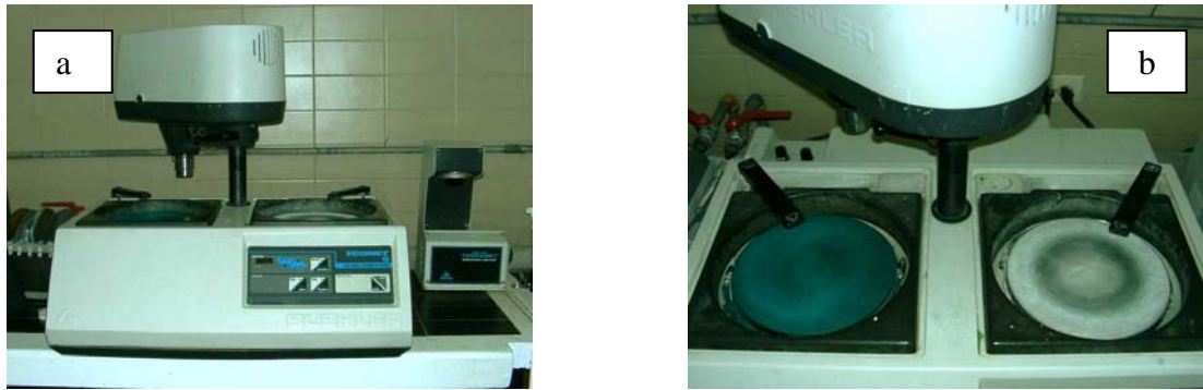
Fig. 3.5. a) Equipo Buehler con platos giratorios. b) Detalle del equipo.
