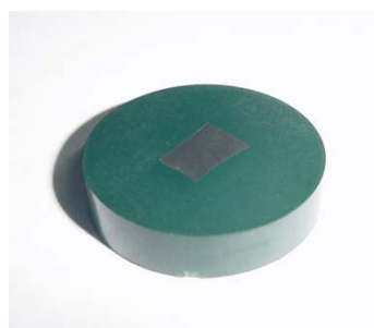
Figura 2.9. Corte Longitudinal (embutido)
