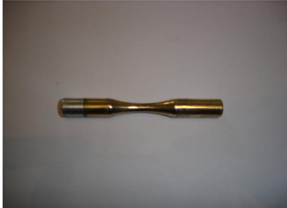
**Figura 2.6** Probeta fabricada para Ensayos de Fatiga y Corrosión-Fatiga.
