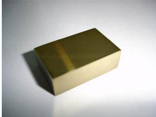
**Figura 2.10** Probeta para evaluación de dureza del recubrimiento de ZrN.
