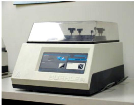
**Figura 2.23** Equipo de desbaste fino por vibración BUEHLER VIBROMET 2.
