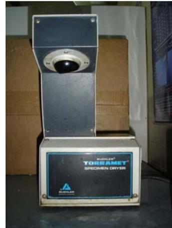
**Figura 2.20** Secador de probetas
