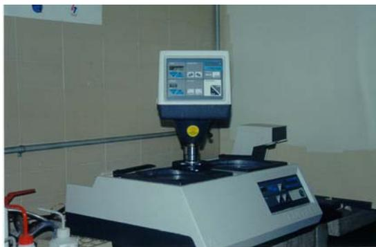
**Figura 2.22** Pulidora para preparación metalográfica BUEHLER ECOMET 5.
