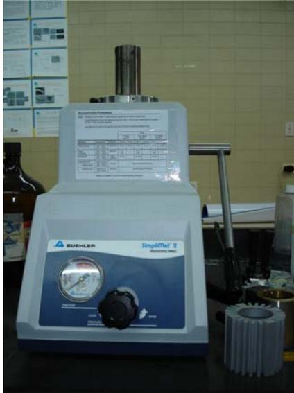
**Figura 2.21** Equipo para embutido de probetas BUEHLER SIMPLIMET 2.
