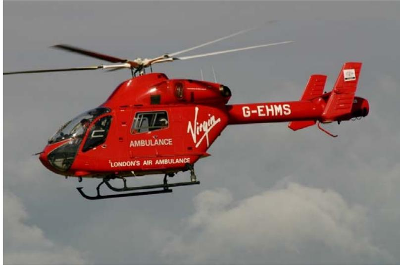
**Figura 1.6** Helicóptero MD900 Explorer. Su tren de aterrizaje es fabricado de 7075-T6.
