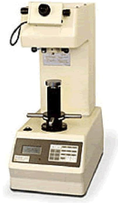
**Figura 2.12** Equipo para medición de microdureza LECO 862-100-100.
