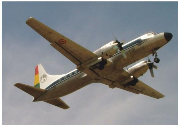
**Figura 1.3** Avión Convair. El fuselaje así como su estructura interna son principalmente de 7075-T6.
