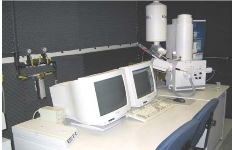
**Figura 2.25** Microscopio Electrónico de Barrido Philips XL 30.
