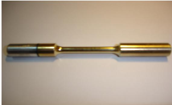
**Figura 2.5** Probeta fabricada para ensayos de tracción.
