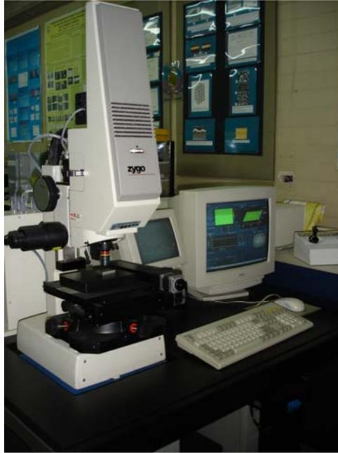
**Figura 2.8** Perfilómetro Zygo.
