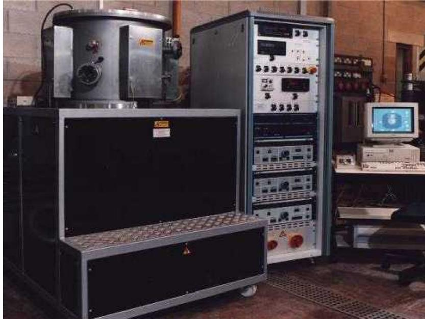
**Figura 2.9** Reactor de bombardeo iónico por magnetrón desbalanceado de campo cerrado.
