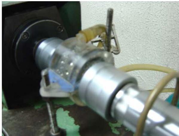
**Figura 2.17** Cámara salina para ensayos de corrosión-fatiga en la máquina Fatigue Dynamics RBF-200.
