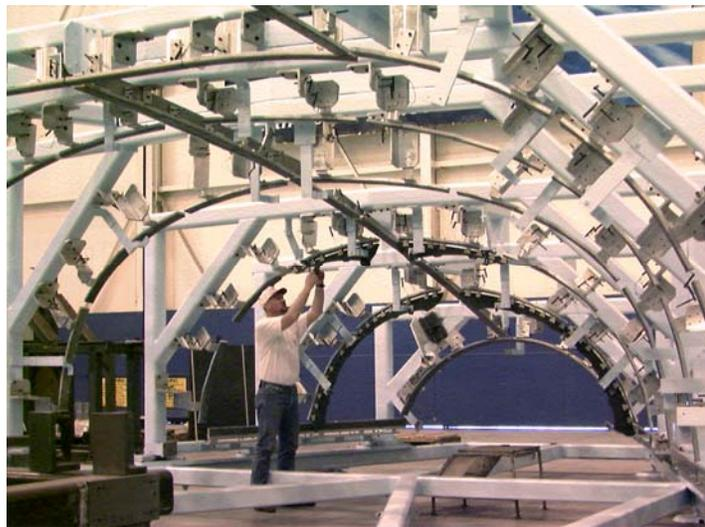
**Figura 1.4** Miembros estructurales fabricados de 7075-T6 para un avión Lockheed.
