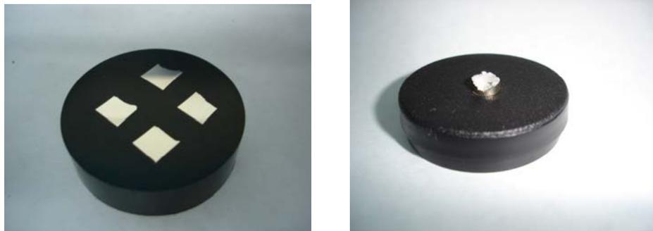
**Figura 2.24** Muestras preparadas para la evaluación fractográfica mediante MEB.
