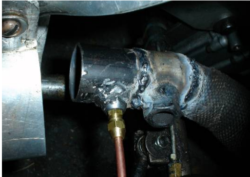
Imagen 25. Disposición de la toma de presión en el escape.
