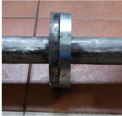
Imagen 6. Tubo principal de la doble cámara de expansión con tubo de conexión interno. Platinas para la sujeción con la carcasa.
