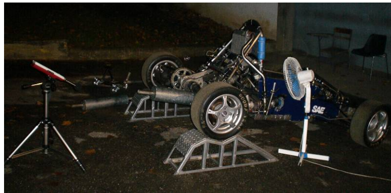
Imagen 20. Disposición del prototipo modelo 2005 para medir ruido con silenciador.
