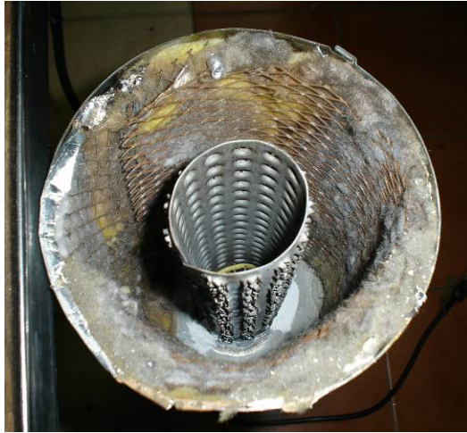
Imagen 19. Resonador con una capa de material absorbente.
