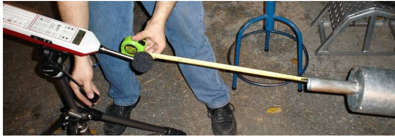
Imagen 22. Medición de la distancia entre la salida del silenciador y el sonómetro
