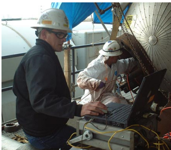
Ilustración 22 Inspección hecha a un calentador por videoscopia a un calentador (Instrument Technology INC. 2005)
