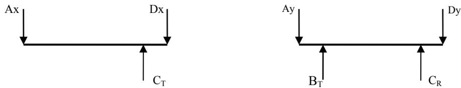
**Figura 9.41** Fuerzas sobre el eje de transmisión b de la alimentadora 2 (2D)
