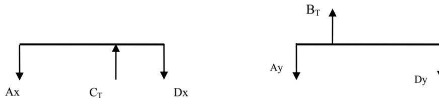
**Figura 9.33** Fuerzas sobre el eje transmisión de la alimentadora 1 (2D)
