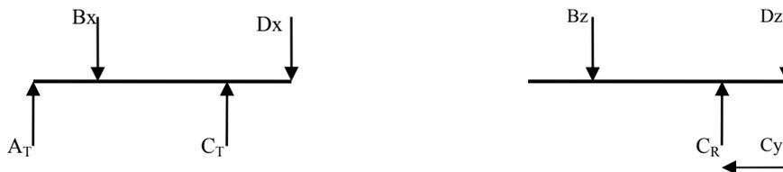
**Figura 9.28** Fuerzas sobre el eje del piñón de ataque de la clasificadora (2D)
