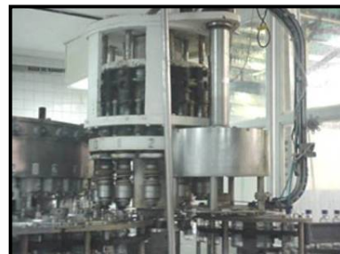
Figura 2.21. Tapadora de Línea 1
