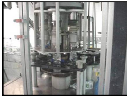
Figura 2.24. Tapadora de Línea 2
