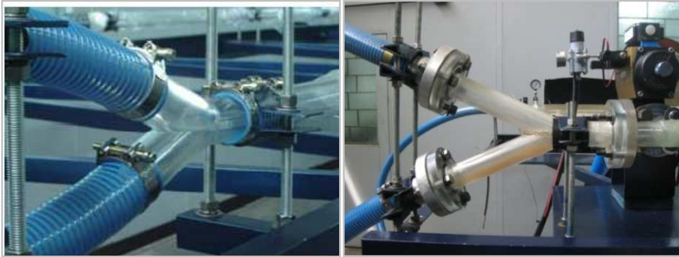
Figura 26. Sección de mezcla (Haoulo, 2007) (Izquierda), Sección de mezcla con uniones mediante bridas (Derecha).
