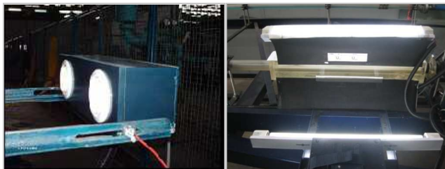
Figura 25. Disposición del sistema de iluminación. Sistema anterior (Izquierda), Sistema Mejorado (Derecha).
