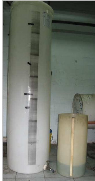
Figura 11. Tanques utilizados para la calibración de las placas orificio.
