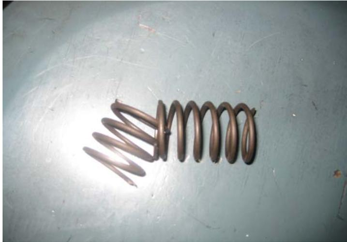
Figura 3.9. Fotografía del Resorte Fracturado
