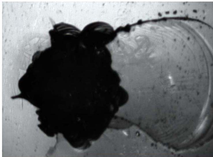
Figura 4.3. Huella dejada en la probeta a los 6.324 ciclos, carga 3.
