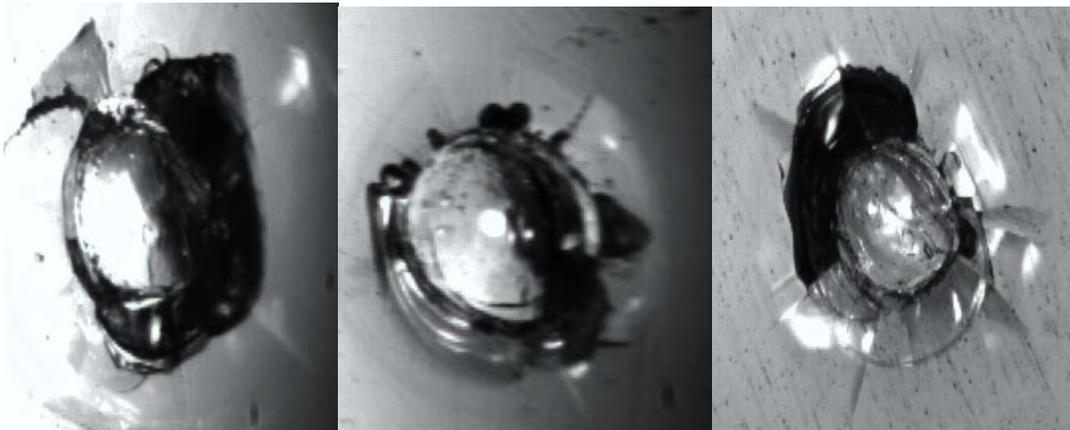
Figura 4.1. Huella dejada en la probeta a 1 ciclo, carga 1, 2, 3.
