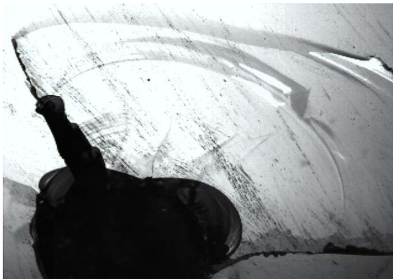
Figura 4.5. Huella dejada en la probeta a los 341.496 ciclos.
