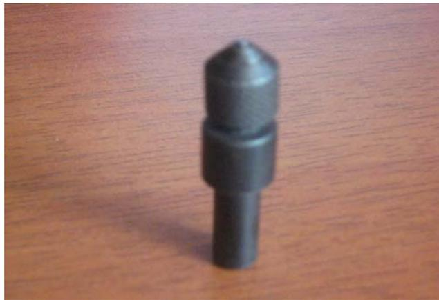
Figura 3.10. Indentador Vickers (deteriorado)
