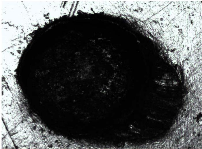
Figura 3.8. Huella dejada por el indentador en la probeta de Aluminio 6063
