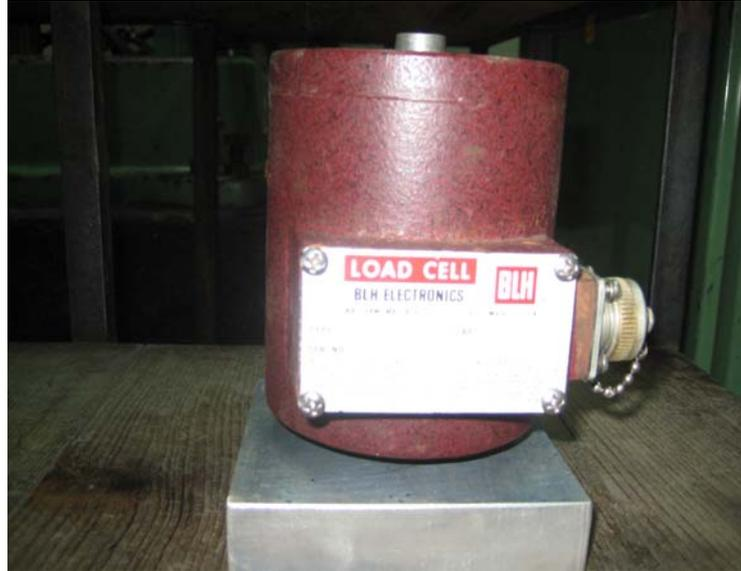
Figura 3.6. Celda de Carga
