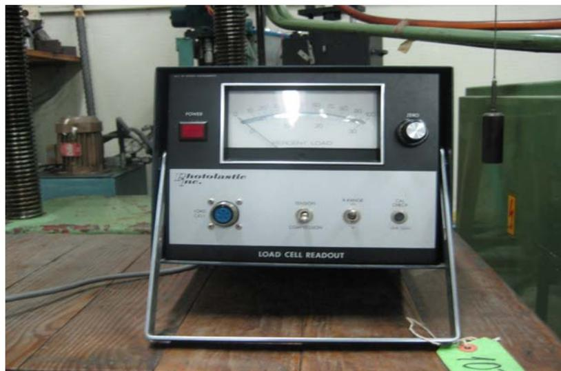
Figura 3.5. Lector de la Celda de Carga.
