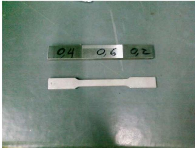
**Figura II.4** Probetas para ensayos de indentación (superior) y de tracción (inferior).
