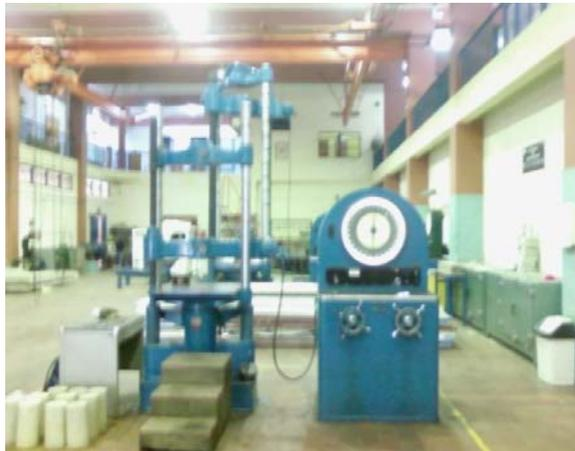
Figura II.6 Máquina Universal de Ensayos
