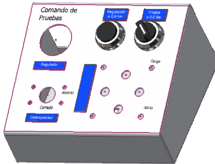
Figura 7. 65. Cajetín de controles y válvulas del área de prueba. Fuente: Los Autores.
