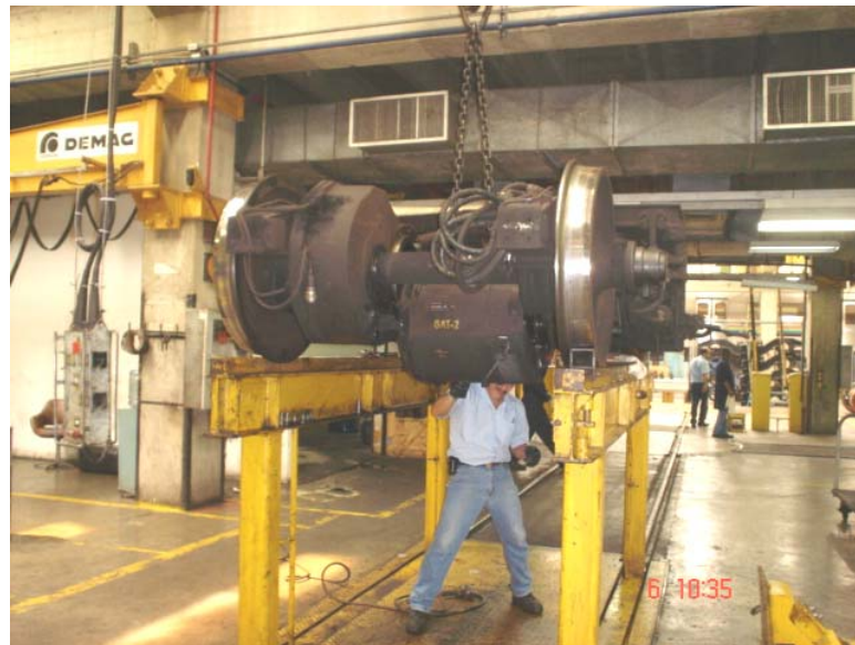
Figura 2. 16. Realización del servicio del Bogie. Fuente: Los Autores.
