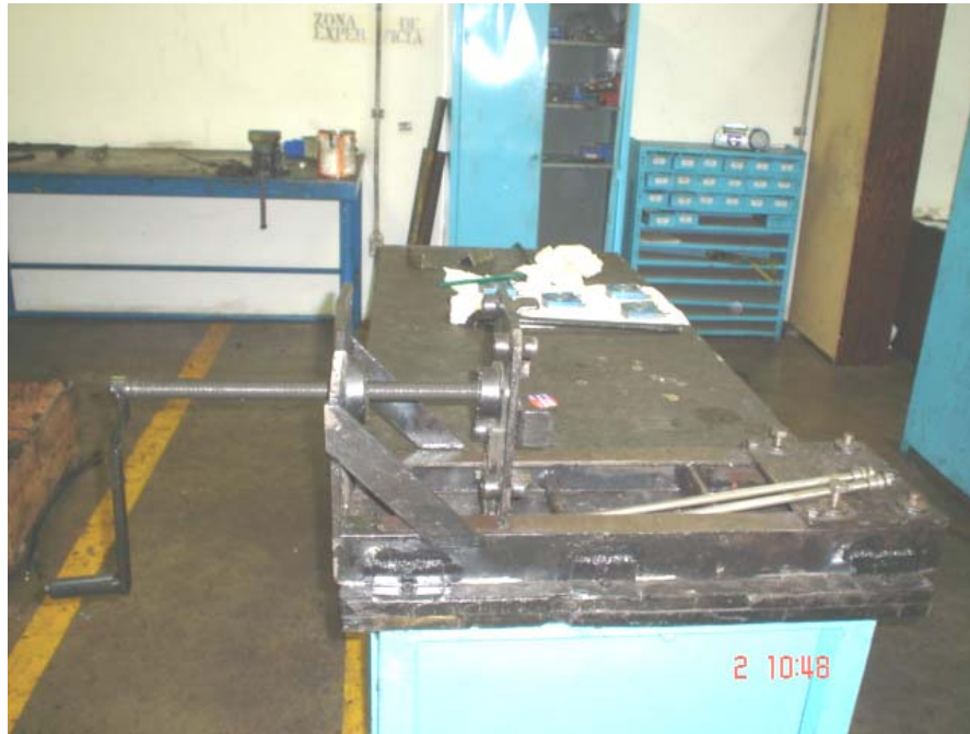
Figura 3. 3. Equipo empleado para el desarmado del Freno de Servicio. Fuente: Los Autores.
