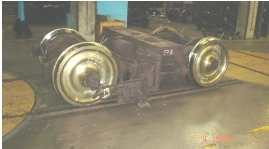
Figura 2. 15. Sistema de rieles para el traslado del Bogie. Fuente: Los autores.
