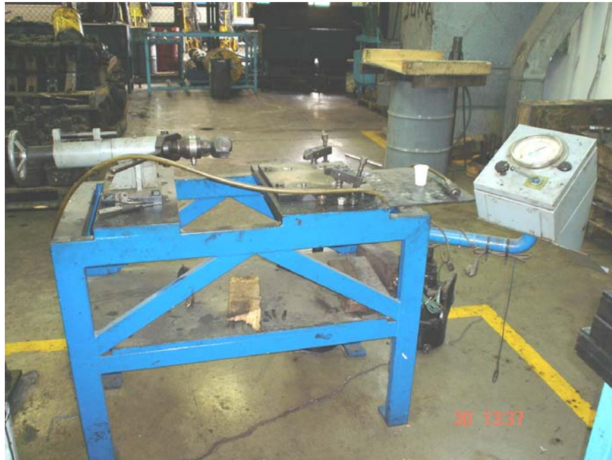
Figura 3. 1. Banco de pruebas del cilindro del Freno de Inmovilización. Fuente: Los Autores.
