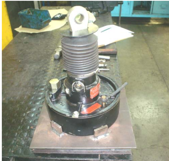
Figura 7. 55. Detalle donde se observa el soporte especial para inmovilizar el Cilindro de Freno. Fuente: Los Autores.
