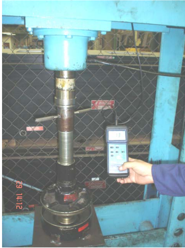
Figura 3. 5. Realización de pruebas para determinar la fuerza a ser ejercida sobre el cilindro de freno por el equipo de servicio.
