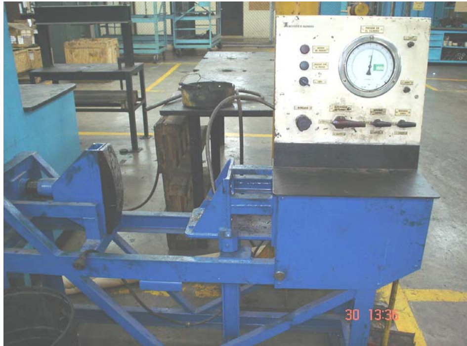
Figura 3. 2. Banco de Pruebas del Cilindro de Freno de Servicio. Fuente: Los autores.
