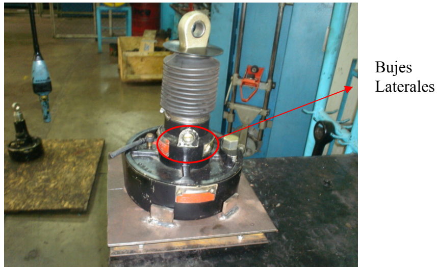
Figura 7. 3. Ubicación de los bujes laterales en el cilindro de freno. Fuente: Los Autores.
