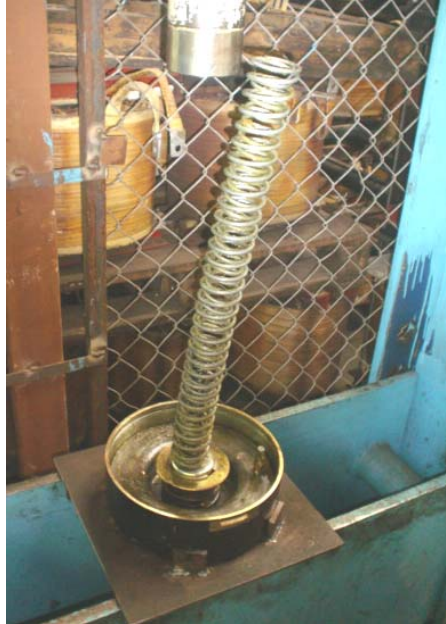
Figura 7. 61. Resortes principales de Cilindro de Freno. Fuente: Los Autores.
