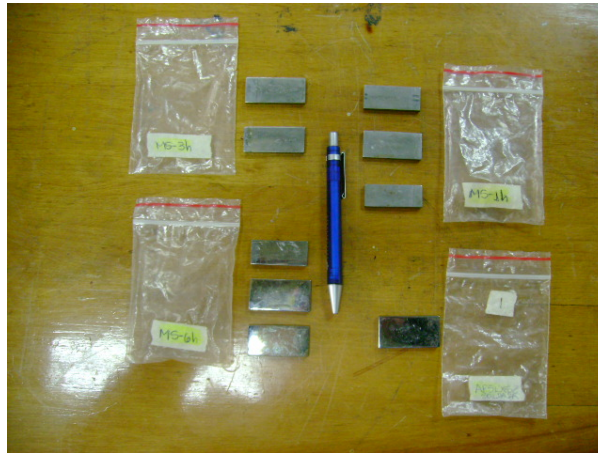
Figura 3.2 Probetas de material soldado
