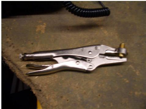
**Alicate de presión con perforador de tubería de cobre**
