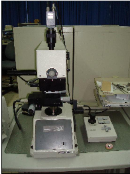
**Fig. 2.8. Durómetro marca Leco**
