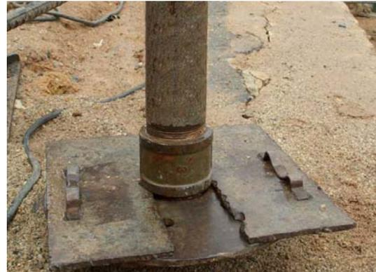
**Fig. 33 - Planchas metálicas para sujeción de conjunto inferior.**
