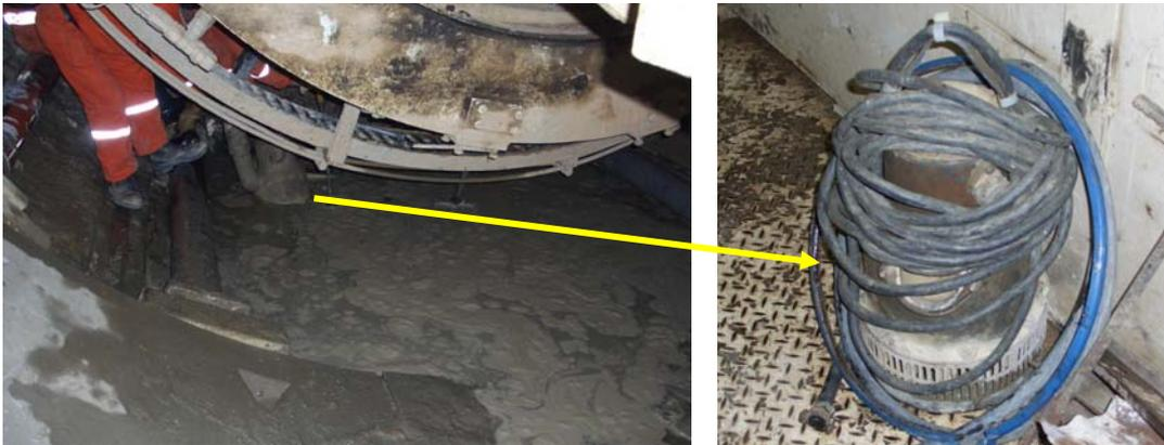
**Fig. 35 - Uso de bombas de achique en la máquina tuneladora.**
