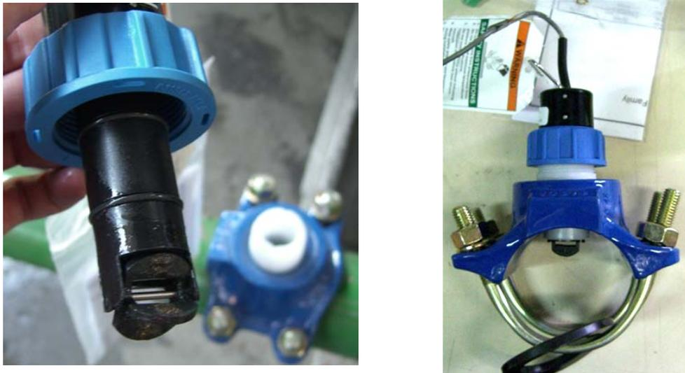
**Fig. 43 - Sensor de flujo marca George Fisher Signet.**
