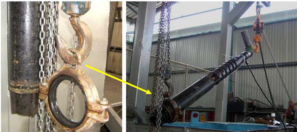
**Fig. 71 - Levantamiento de bomba Leão con aro de izamiento.**
