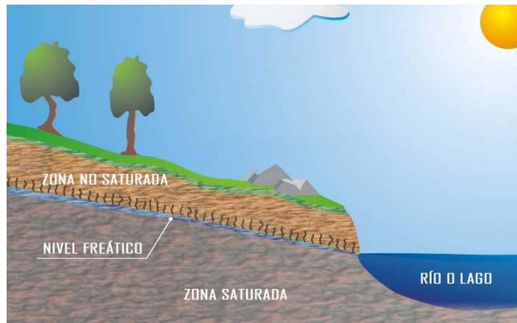
**Fig. 1 - Diagrama del nivel freático.**
