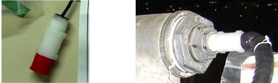
**Fig. 44 - Sensor de Presión marca George Fisher Signet.**
