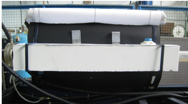
Figura 20. Colocación de anime comprimido en las paredes superior, inferior y posterior de la caja de Visualización.
