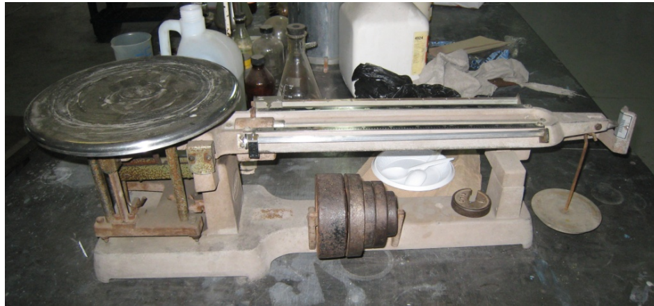
Figura 31. Balanza marca OHAUS, apreciación: \pm 0,001 kg. Ubicada en el Laboratorio de Operaciones Unitarias, Escuela de Ingeniería Química UCV.
