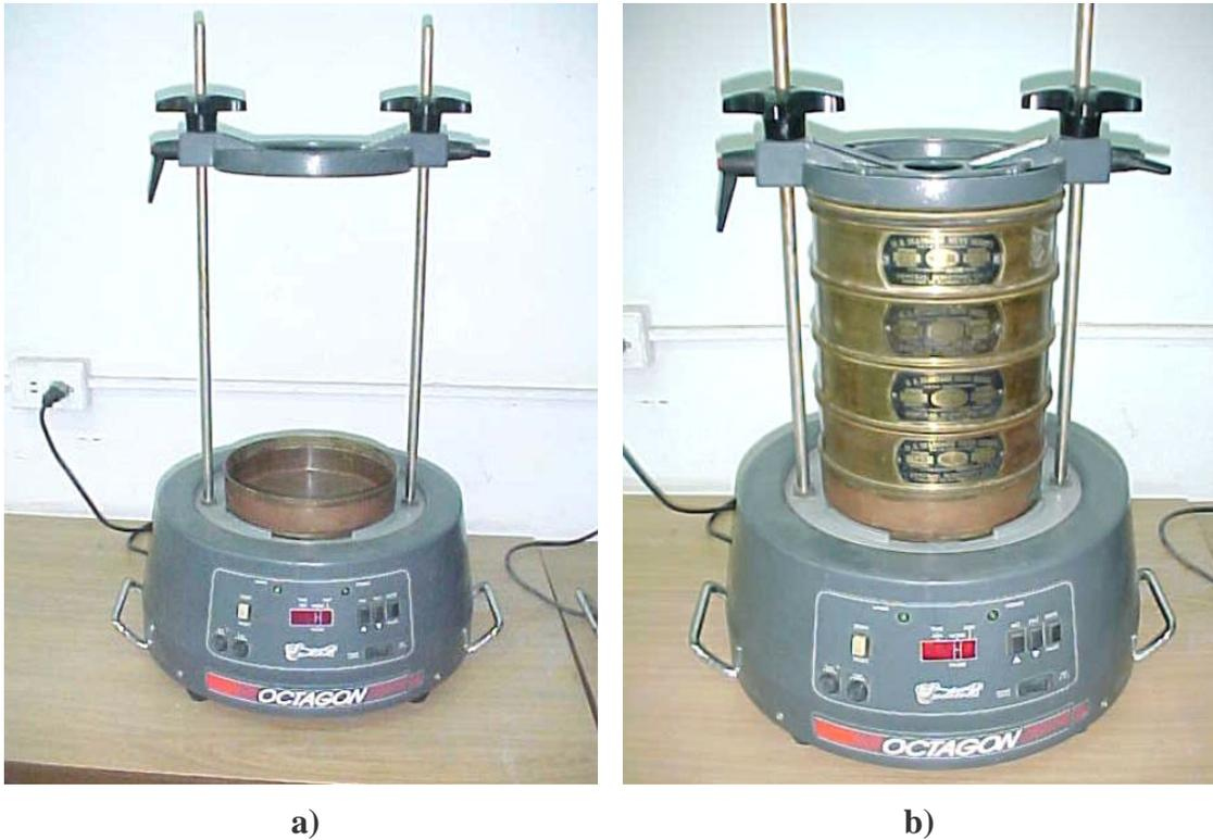
**Figura 3.6. Tambor vibratorio OCTAGON para tamizado. a) Sin tamices. b) Con tamices 30, 40, 50, 70, 100, de arriba a abajo.**
