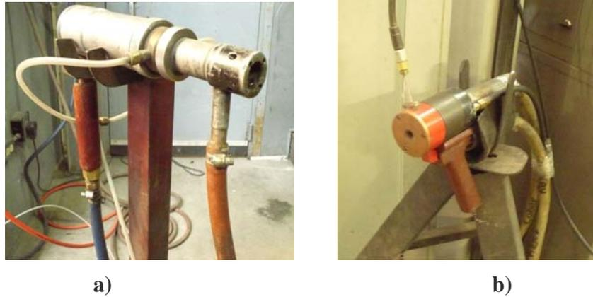
**Figura 3.3. a) Pistola de Plasma SG-100 con acoplamiento a servomotor.
