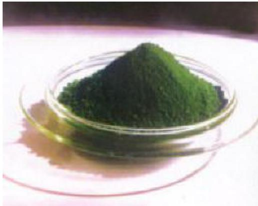
**Figura 2.3.** El "verde de cromo" (es el óxido de cromo (III),  $\text{Cr}_2\text{O}_3$ )
