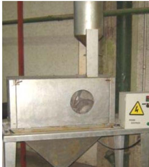
**Figura 3.7. Máquina para ensayo de abrasión**
