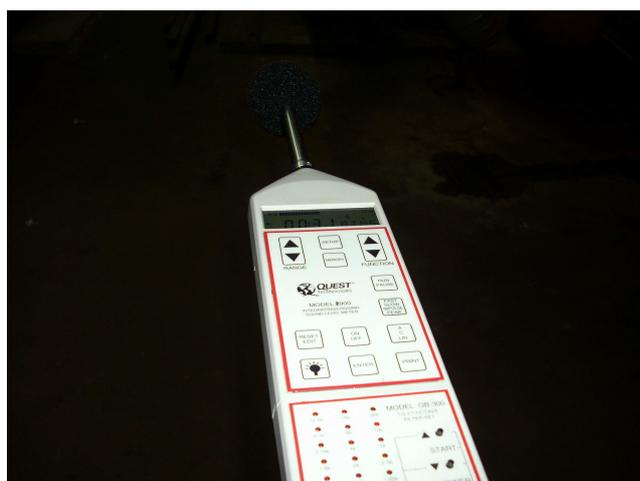
**Foto 3. Sonómetro marca Quest modelo 1900 con el protector contra viento. Fuente: Los**
