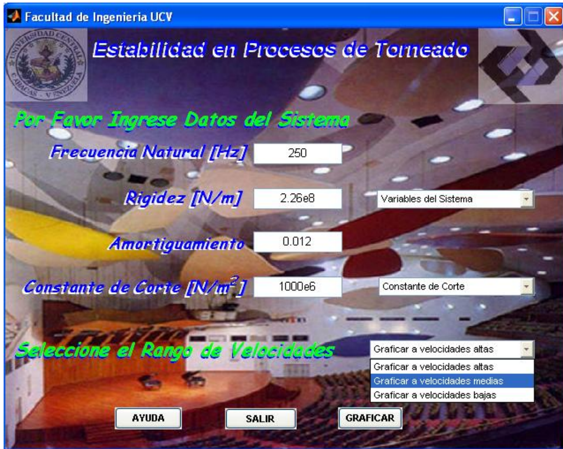
Fig. 36: Pantalla principal de la interfaz gráfica con despliegue de menú de velocidades (Fuente: Los autores)
