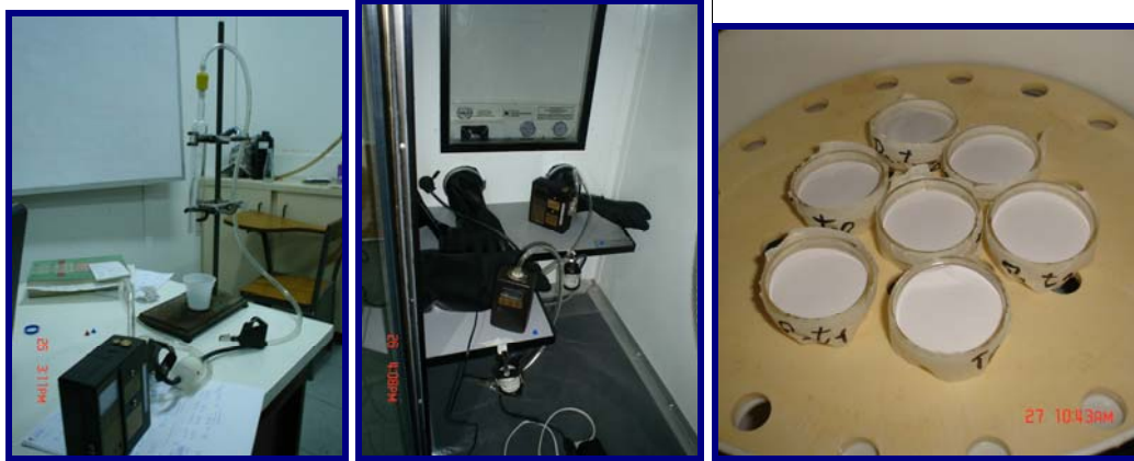
Figura 5.5.- De izquierda a derecha: Calibración de las bombas, realización de la prueba y desecado de los filtros
