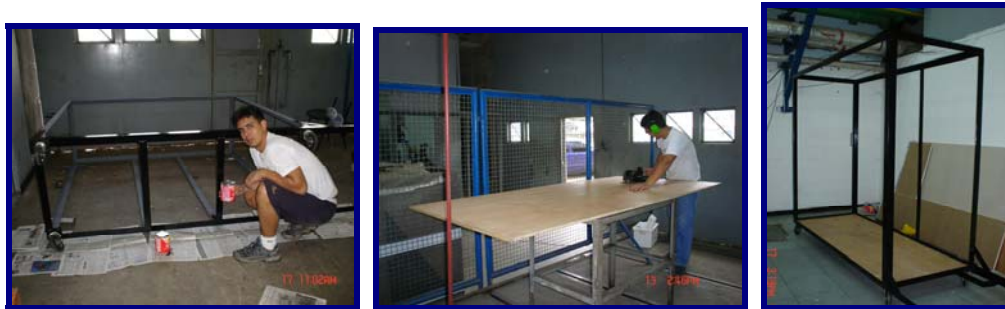
Figura 4.3.- De izquierda a derecha: Aplicación de pintura negra, corte del compuesto, estructura con piso
