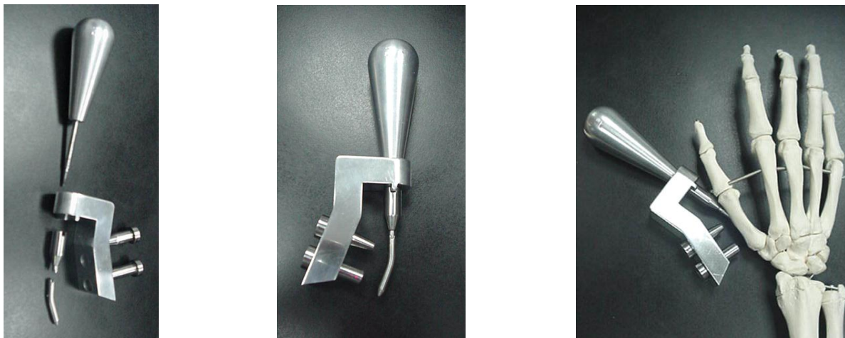
Fig. 5.17 Prototipo final de la herramienta para la inserción y bloqueo de un sistema intramedular para el tratamiento de fracturas diafisarias en el primer metacarpiano. En la figura se muestra un despiece de la herramienta con todas sus partes incluidas y una simulación de cómo se dispone el instrumento con respecto a la posición de la mano.
