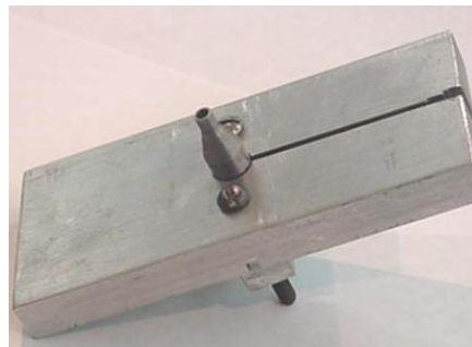
Fig. 5.10 Montaje del conector en el orificio del cuerpo principal del utillaje para la fabricación de los dientes que posteriormente se insertarán en las entallas del clavo
