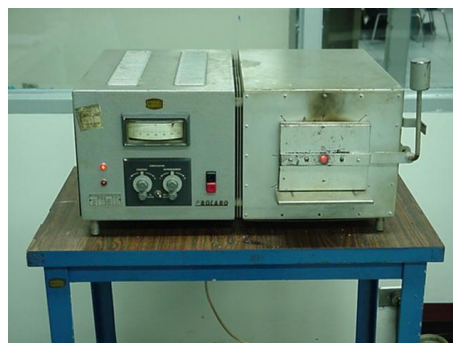
Fig. 5.15 Horno donde se realizó el tratamiento térmico de las piezas, ubicado en el Laboratorio de Procesos Especiales de la Escuela de Ingeniería Mecánica. Rango de temperatura: 0-1200°C
