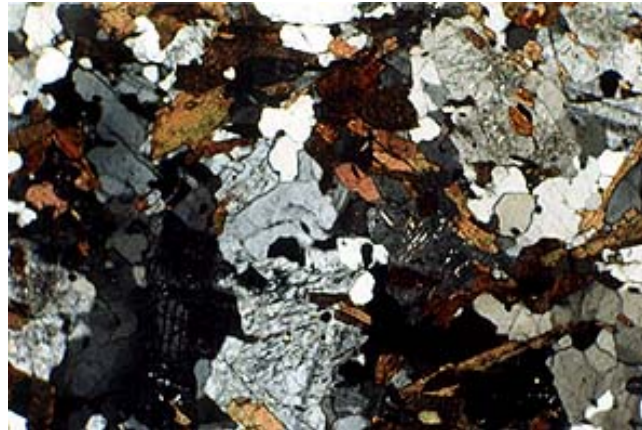
Figura 5.7: enclave microtonalítico. La plagioclasa muestra alteración (eje menor = 2,26 mm)
