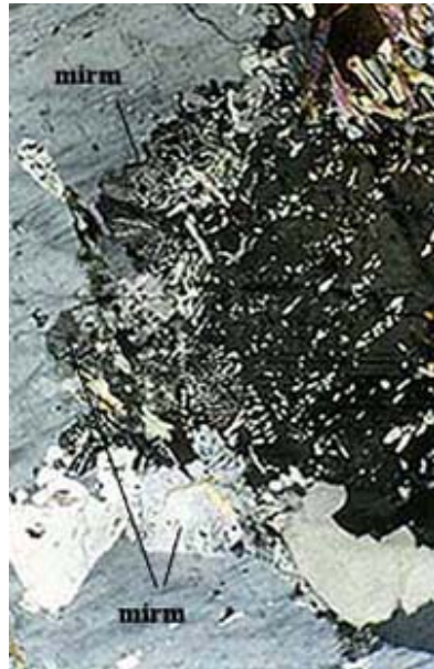
Figura 6.25: un cristal de plagioclasa, con desarrollo de mirmekitas en el contacto con un fenocristal de feldespato potásico (TV-016; metamonzogranito ).
