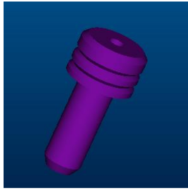
Figura 4.13 Casquillo de inserción, guía que permite la introducción del tornillo de cortical, sin necesidad de intensificador de imágenes
