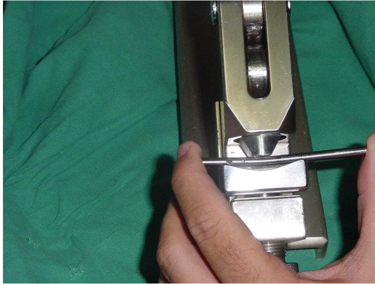
Figura 4.23 Proceso de doblado del clavo
