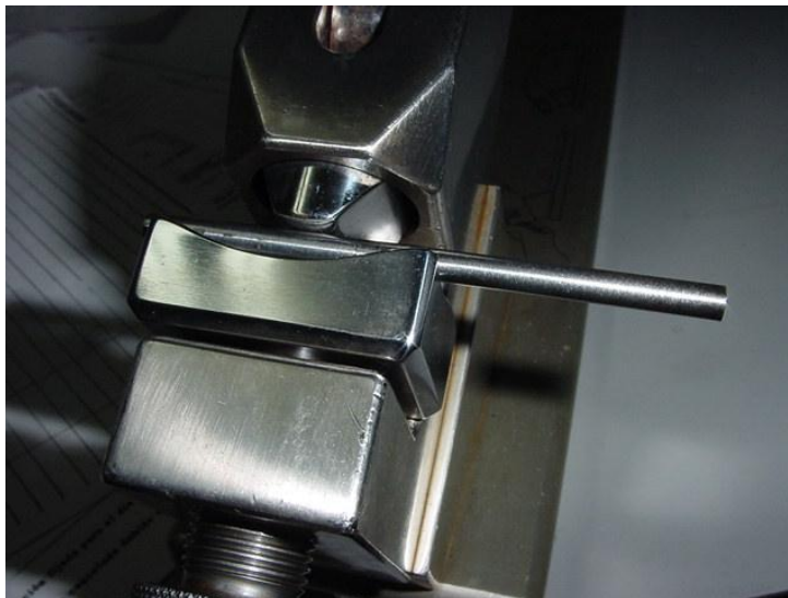
Figura 4.22 Montaje del clavo en la dobladora de placa A.O.
