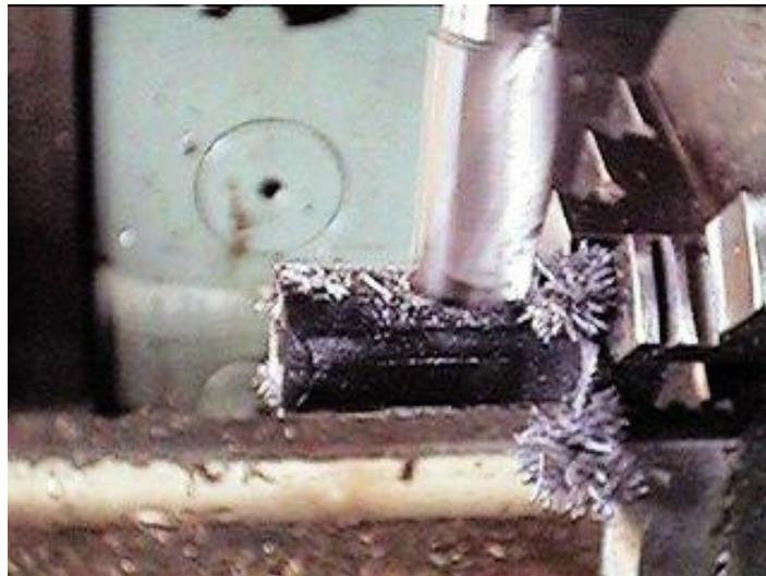
Figura 4.26 Fresado de una las caras del tocho de aluminio
