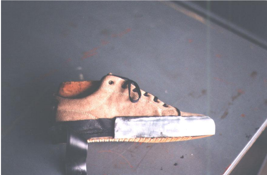
Fig. 1.2. Zapato montado aplicándose la cinta de goma cruda
