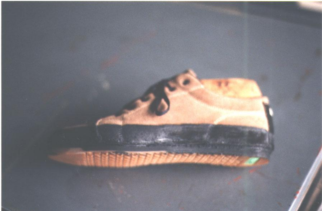
Fig. 1.1. Zapato montado en su horma con pegamento
