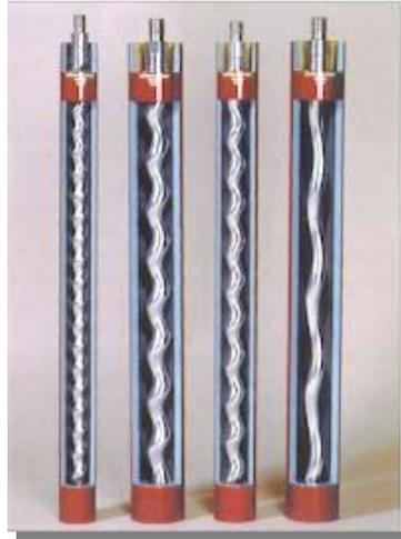
**Fig. 2.8.** Rodetes de bomba de cavidad progresiva
