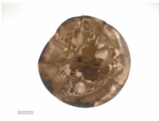
**Figura 13.** Asfaltenos filtrados y secados. Fuente propia.
