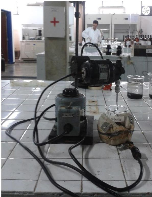
Figura 17. Montaje para el mezclado residual-fracción.
