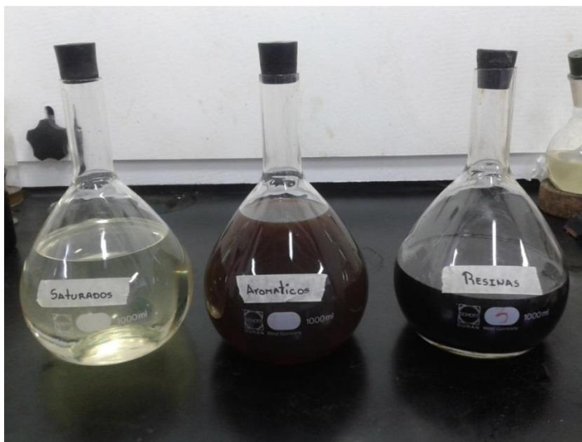
**Figura 16.** Fracciones obtenidas por medio de la separación Macro-S.A.R.A.
