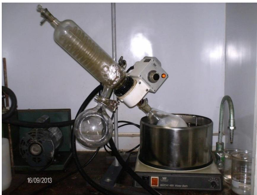
**Figura 15.** Montaje para la separación de las fracciones del residual (rotovaporador, baño de calentamiento y bomba de vacío)
