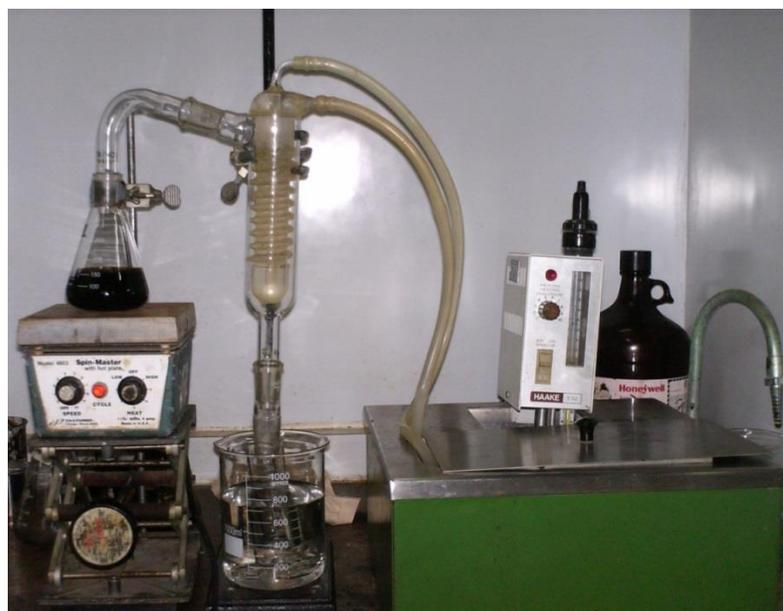
**Figura 12.** Montaje para la separación asfaltenos-maltenos
