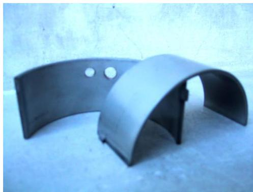
Fig.6 Cojinetes de deslizamiento.
