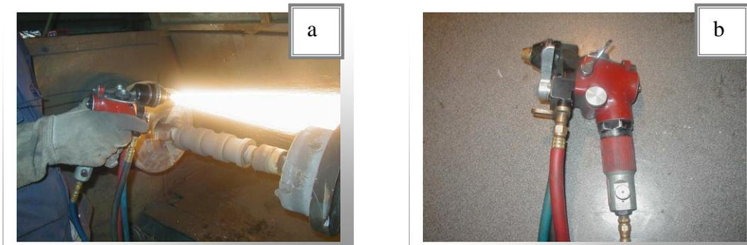
Fig. 9 a) Proceso HVOF. b) Pistola M-Jet 5 de HVOF.
