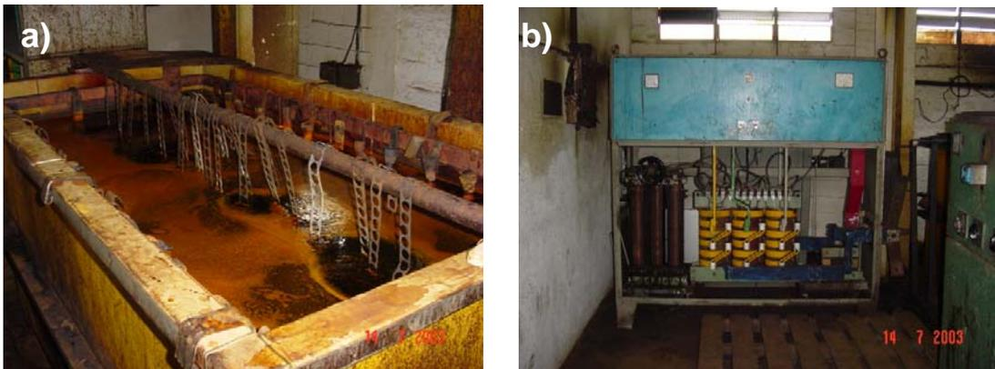
Figura 2.5 a) Tina electrolítica que contiene las soluciones de cromo que se depositan sobre el substrato., b) Unidad de regulación de la corriente aplicada en el proceso
