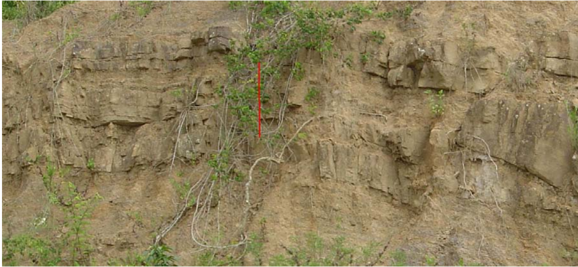
Figura 3.84 Afloramiento de calizas y lutitas de la Formación Churuguara, en la zona 6248-II, de baja frecuencia de diaclasamiento, rumbo de la foto S40E (el segmento es equivalente a un metro).
