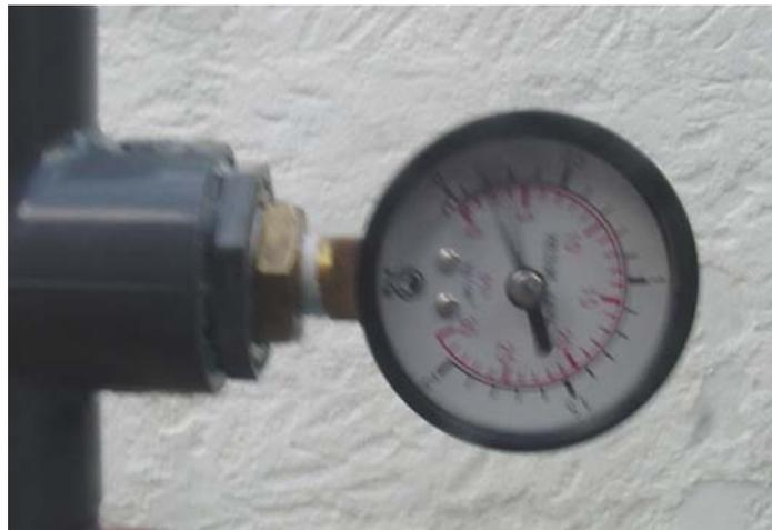
**Fig. 5.8.** Medición de presión ( $P_2$ ) aguas abajo.
