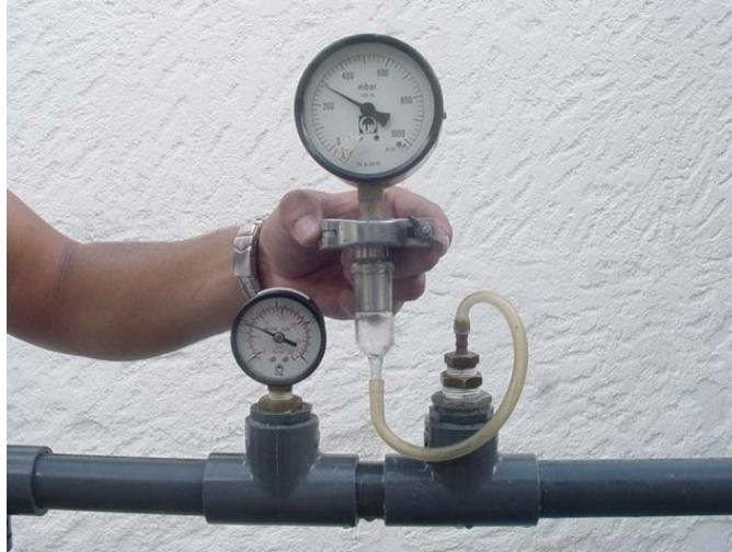
**Fig. 5.5.** Instrumentos de medición de presión en el eyector.
