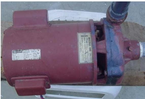
**Fig. 4.1.** Bomba Centrífuga utilizada para el tratamiento.
