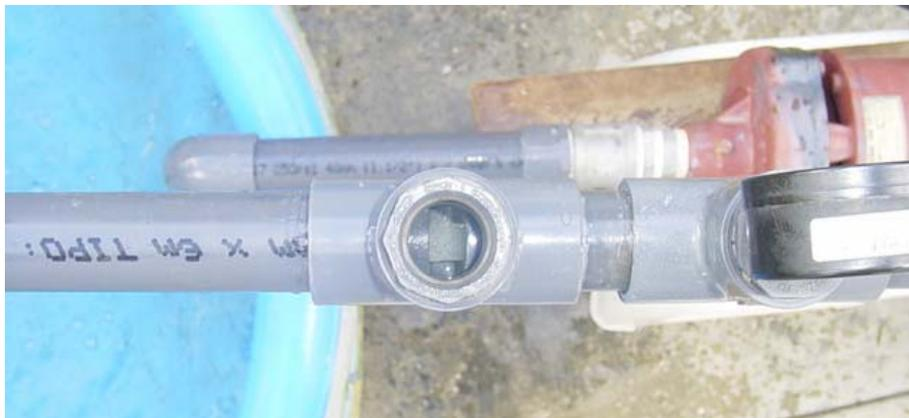
**Fig. 6.2.** Eyector en funcionamiento.
