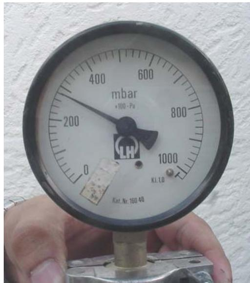
**Fig. 5.6.** Toma de presión de succión con el vacuometro.
