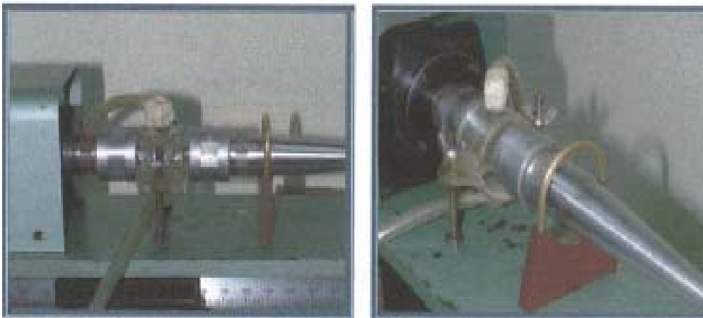
FIGURA 18.- Cámara de corrosión
