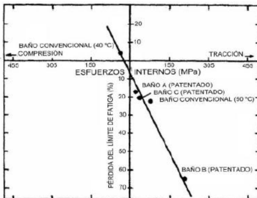
FIGURA 9. Relación lineal entre el porcentaje de cambio en la resistencia a la fatiga del acero recubierto con cromo y los esfuerzos residuales de varios tipos de depósitos de cromo sin post-tratamiento térmico [1] .
