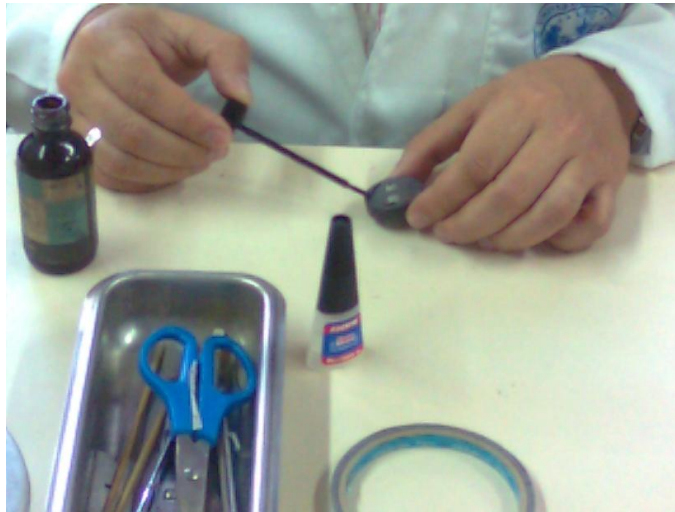
Figura N°24. Colocación del grafito conductor a las muestras.
