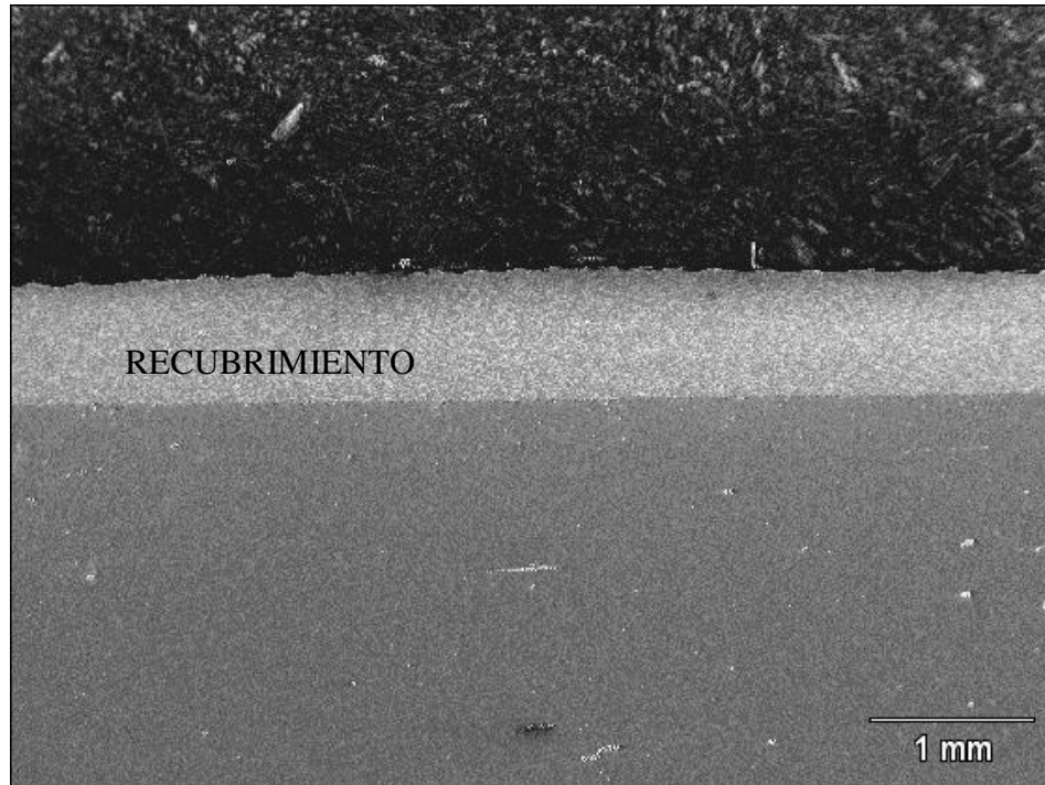
Figura N°42. Vista general del espesor del recubrimiento que ha sido proyectado térmicamente sobre el acero AISI 4340. Aumento 20x.
