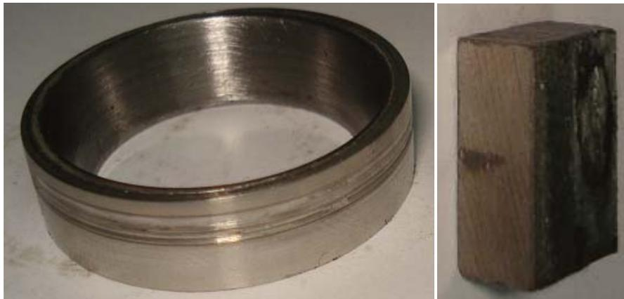
Figura 12. Bloque y anillo del quinto ensayo Bloque R-10 vs Anillo Babbit
