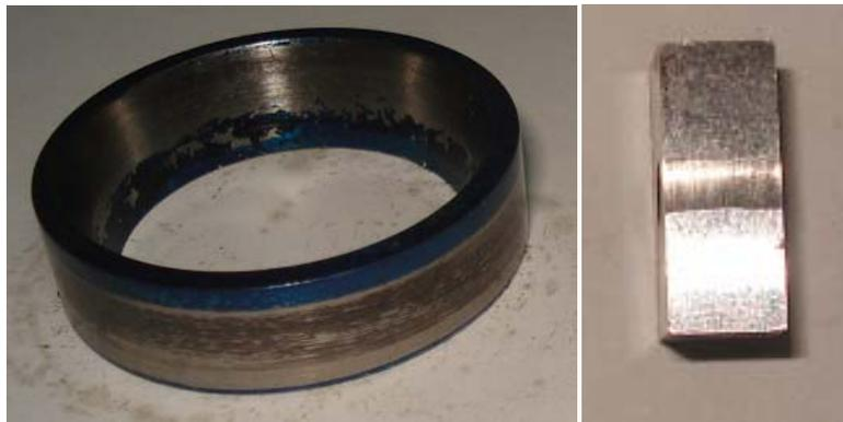
Figura 6. Bloque y anillo del primer ensayo Bloque Falex H-30 vs Anillo Falex
