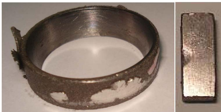
Figura 8 Bloque y anillo del primer ensayo Bloque R-10 vs Anillo Babbit
