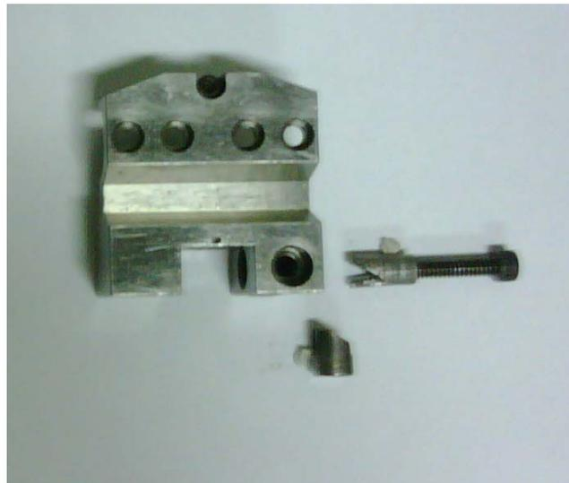
Figura 4. Tornillo pasador de apriete para montura de bloques
