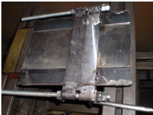
Figura 14. Soporte para montura de bloques en Rectificadora Horizontal
