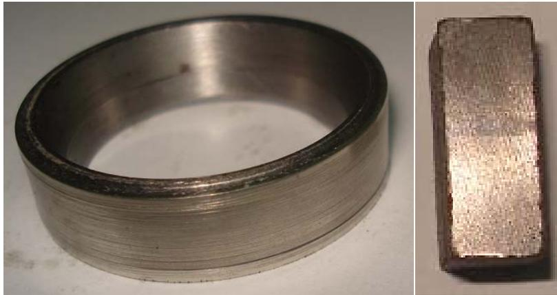
Figura 10. Bloque y anillo del tercer ensayo Bloque R-10 vs Anillo Babbit
