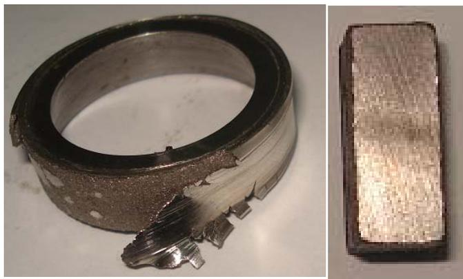
Figura 9. Bloque y anillo del segundo ensayo Bloque R-10 vs Anillo Babbit
