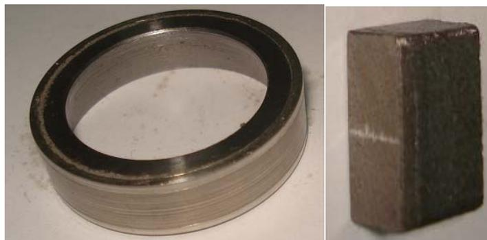
Figura 11. Bloque y anillo del cuarto ensayo Bloque R-10 vs Anillo Babbitt
