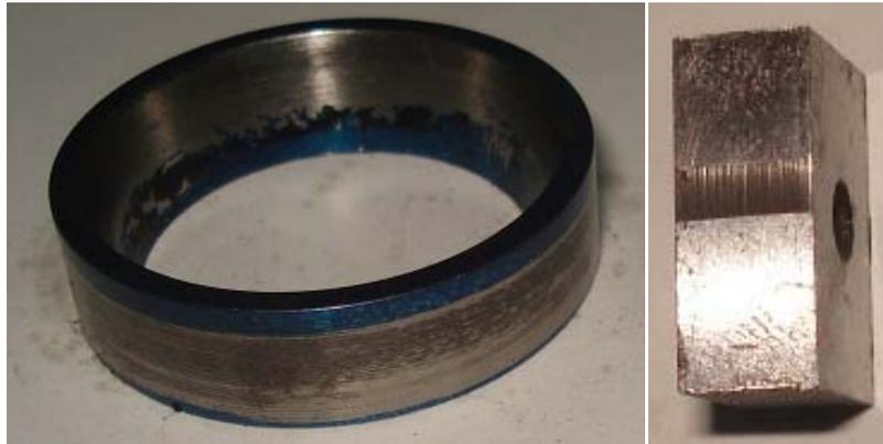
Figura 15. Bloque y Anillo Ensayo Block on Ring de calibración
