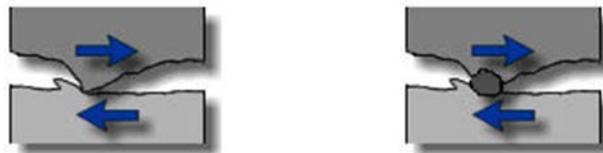
Figura 2.7 Desgaste de dos cuerpos y desgaste de tres cuerpos
