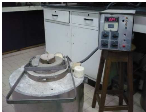
Figura 2.7. Horno de resistencia eléctrica para tratamientos térmicos.
