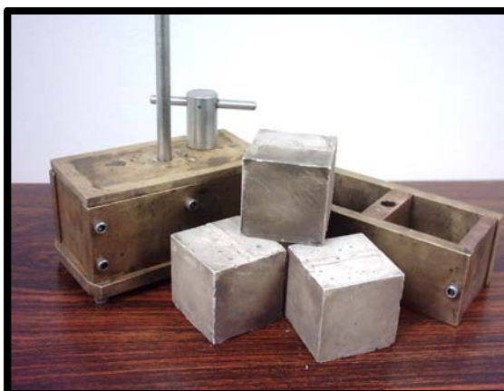
Figura 43: Muestra de los cubos obtenidos con el lodo cementante C a 12,5 lpg para los ensayos de resistencia a la compresión mediante el ensayo destructivo
