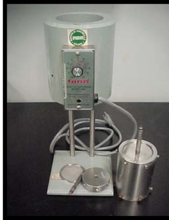
Figura 33: Cámara de filtrado
