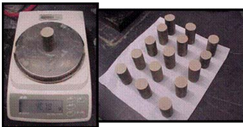
Figura 44: Determinación de la masa de los núcleos
