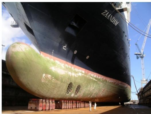
**Figura 2.25. Embarcación con casco en forma de bulbo.**
