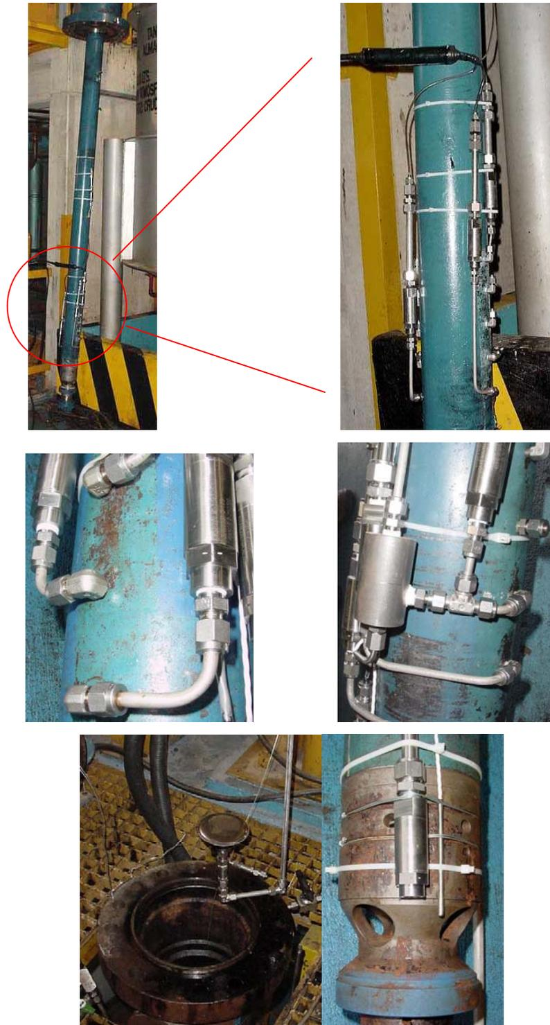
Figura 18 Vista de sensores en la bomba electrosumergible
