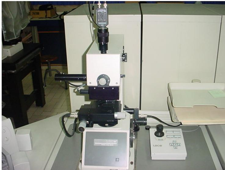
**Figura 2.6.-** Microdurómetro.
