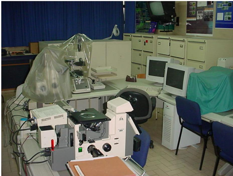
**Figura 2.7.-** Microscopio óptico marca Olimpo modelo PMG3, acoplado a un analizador de imágenes marca Leco modelo AI300I.
