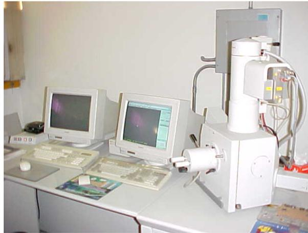
**Figura 2.9.-** Microscopio electrónico.
