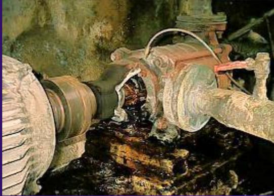
Detalle de la carcasa deteriorada de una de las bombas
