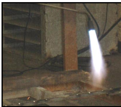
Figura 3.3. Pre calentamiento de las probetas con llama oxiacetilénica.
