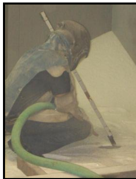
Figura 3.4. Proceso de arenado con alúmina \text{Al}_2\text{O}_3 .
