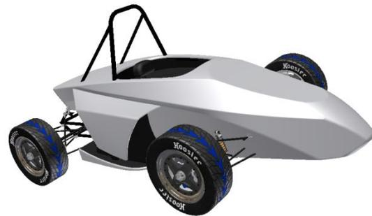
Figura 3.18. Dibujo del carenado a partir del ensamble del prototipo *Formula SAE UCV* 2009
