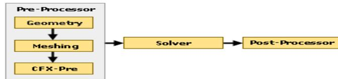
Figura 3.21. Conjunto de módulos del *software* de simulación
