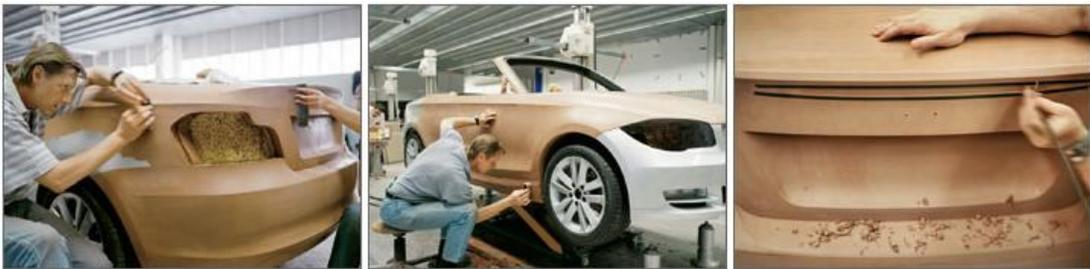
*Figura 2.22.* Modelo en arcilla del BMW 1 Series Convertible
