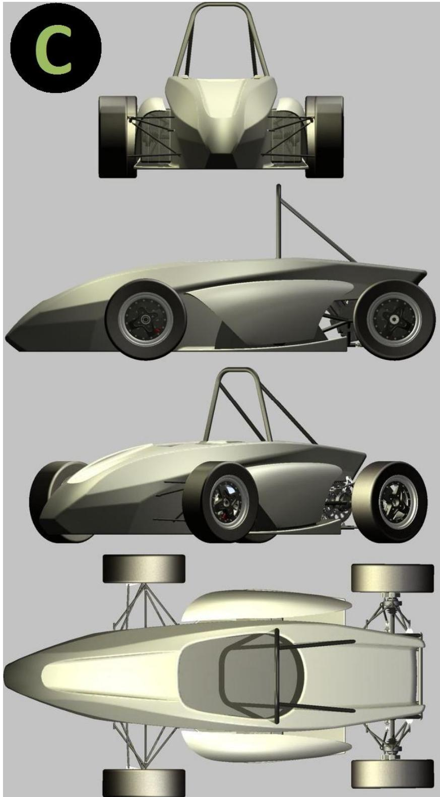
Figura 3.30. Vistas ortogonales del carenado C
