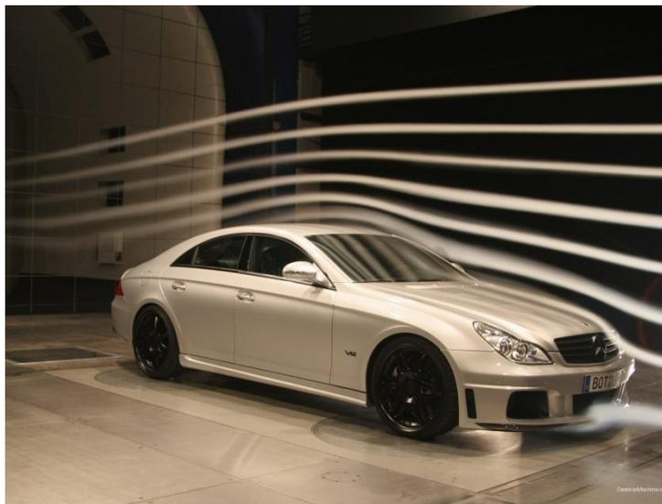
Figura 2.13. Ensayo de un Mercedes-Benz en túnel de viento, sobre básculas
