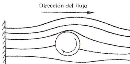
Figura 2.9. Experimento de Rayleigh sobre un cilindro con rotación
