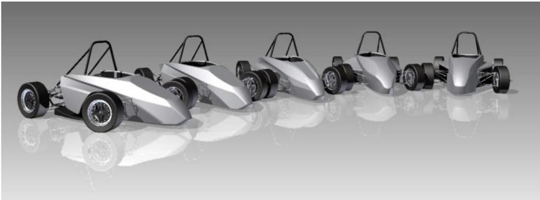
*Figura 3.2.* Los cinco carenados en estudio, de izquierda a derecha: E, D, C, B y A
