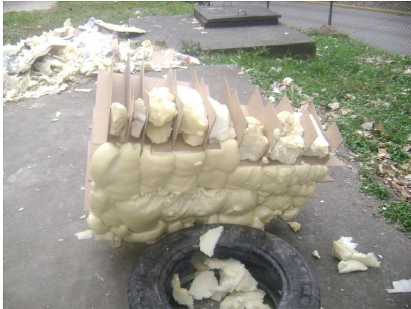
Figura 2.32. Relleno del esqueleto con poliuretano.
