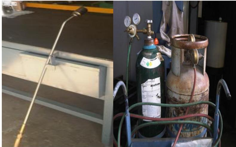
**Figura 3.6** Soplete quemador de oxiacetilénico marca Harris.
