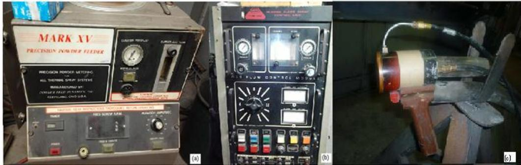
**Figura 3.5** (a) Alimentador de polvos modelo Mark XV, (b) Unidad de control marca Metco, tipo 7MC Plasma Flame Spray Control Unit y (c) Pistola Thermal Inc. SG-100.
