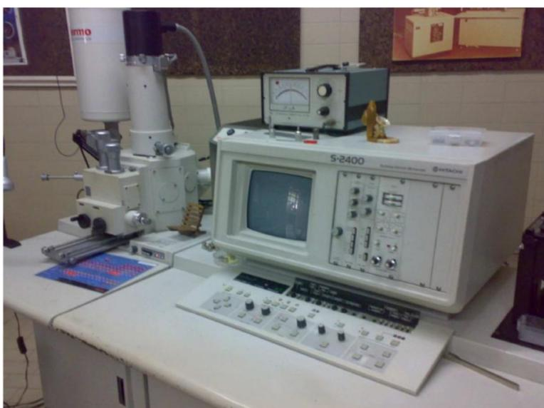
**Figura 3.9** Equipo de Microscopía Electrónica de Barrido Hitachi S-200
