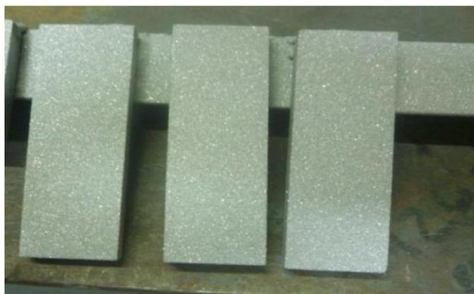
**Figura 3.4** Substrato después del Sand Blasting.
