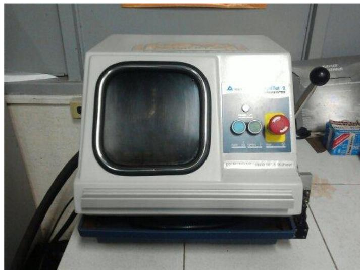
**Figura 3.8** Máquina de corte BUEHLER SamplMet 2.
