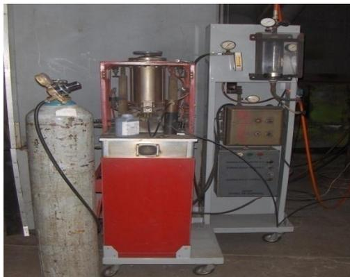
Figura 3. 6: Equipo de aplicación de termorociado HVOF.
