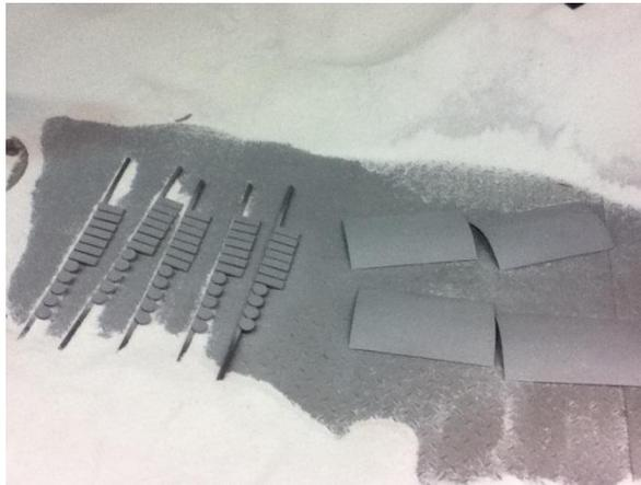
Figura 3. 5: Probetas después de aplicar el arenado.
