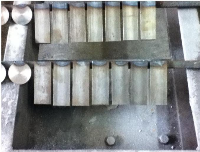
Figura 3. 3: Fijación de los especímenes a recubrir.
