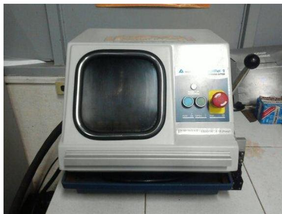
**Figura 3. 1: Máquina de corte BUEHLER SamplMet 2.**
