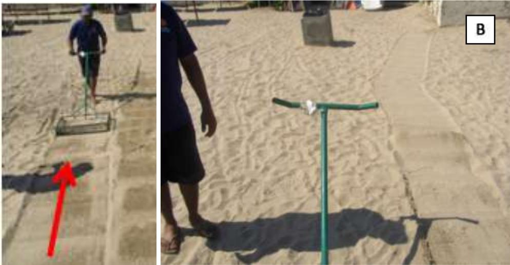
**Figura 72**– Detalles de la rastra de limpieza utilizada en la playa del Balneario Marina Grande, Edo. Vargas A) Dirección del movimiento (flecha roja) B) Manubrio ya modificado
