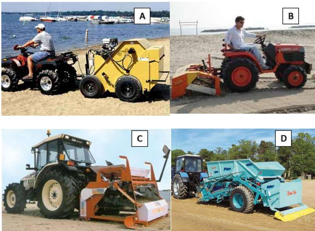
**Figura 45** – Equipos mecánicos tipo remolque. A) Equipo remolcado por una moto de 4 ruedas, Cherrington model 800 Beach Cleaner. B, C y D) Equipos remolcados por tractores de diferentes tamaños. B) PFG Cernia C) PFG Balena D) Beach Tech 3000
