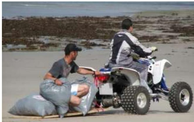
**Figura 47** – Equipo remolcados por una moto de 4 ruedas, utilizado para transportar las bolsas con la basura recolectada fuera de la playa. El mismo consta de una tabla simple amarrada a la parte posterior de la moto. Foto tomada en la II jornada de limpieza de la Playa Nemiña, Brasil, 2008.
