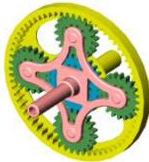
**Figura 90** – Sistema de transmisión planetaria
