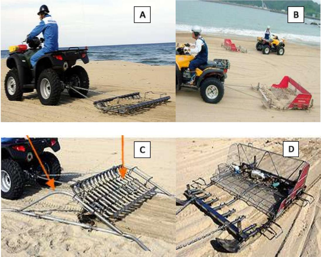
**Figura 46** – Equipos mecánicos remolcados por una moto de 4 ruedas. A y B) Dos diferentes tipos de remolque en acción. C y D) Dos modelos diferentes de equipo
