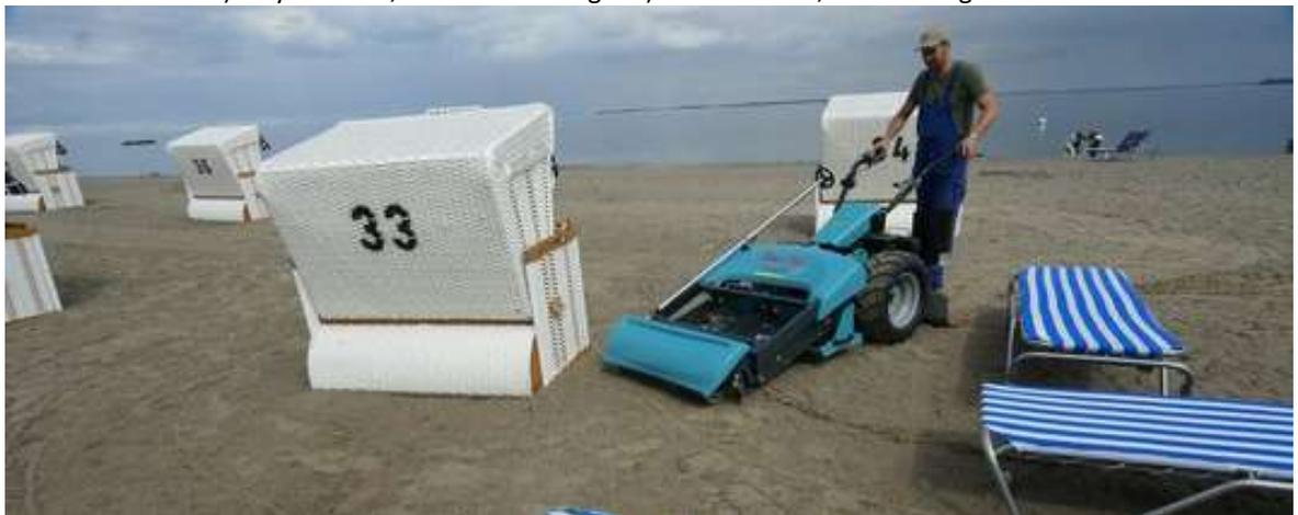
**Figura 78** – Limpieza entre obstáculos realizada con un equipo mecánico autopulsado no tripulado
