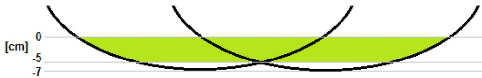
Figura 98 – Área de limpieza que se garantiza si la profundidad de corte es de 5cm
