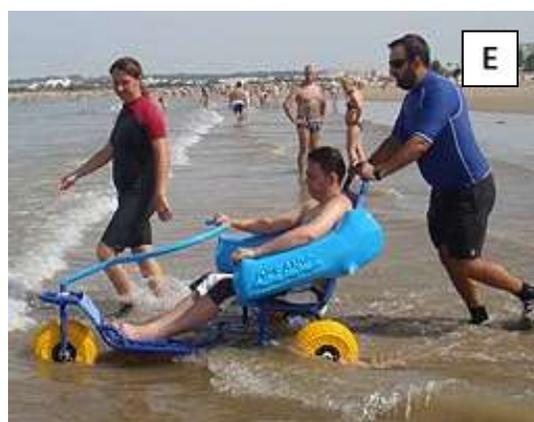
**Figura 55** – Sillas de ruedas anfibas para playa. A) Silla anfibia Neptune B) Silla anfibia Oceanic C) Silla anfibia Oceanic en la zona de vaivén D) Silla anfibia Oceanic siendo “empujada” mientras flota dentro del agua gracias a la forma curvada de su barra de dirección y tracción E) Silla anfibia Oceanic siendo dirigida por el pasajero, gracias al diseño del acople barra-silla, mientras una segunda persona la empuja.
