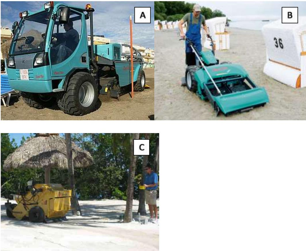
**Figura 48** - Equipos mecánicos autopropulsados. A) Equipo autopropulsado tripulado Beach Tech Marina. B) Equipo autopropulsado no tripulado, BeachTech Sweepy Hidro. C) Equipo autopropulsado no tripulado Cherrington Model 950 Beach Cleaner. Este equipo tiene la particularidad de ser manejado mediante un mando a distancia.
