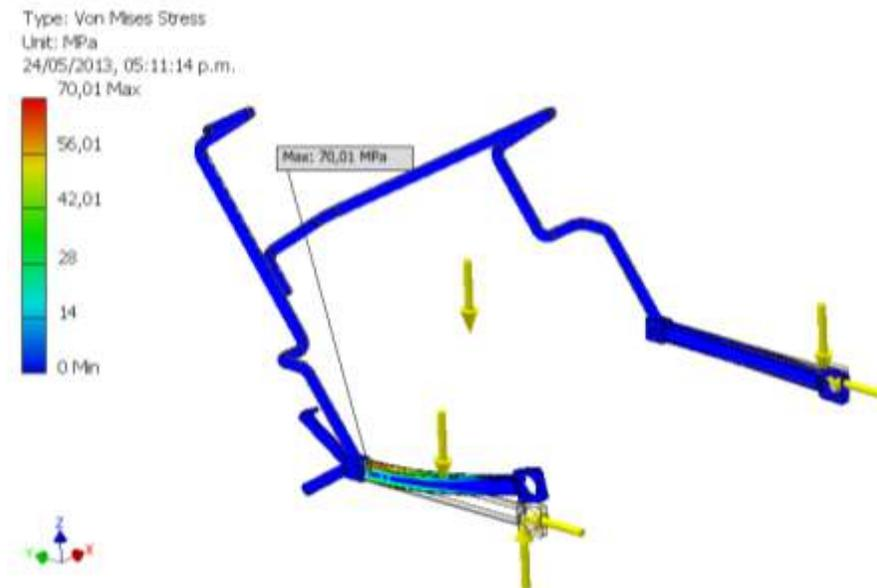
**Figura 141** – Esquema de esfuerzos a los que está sometido el sistema de izamiento
