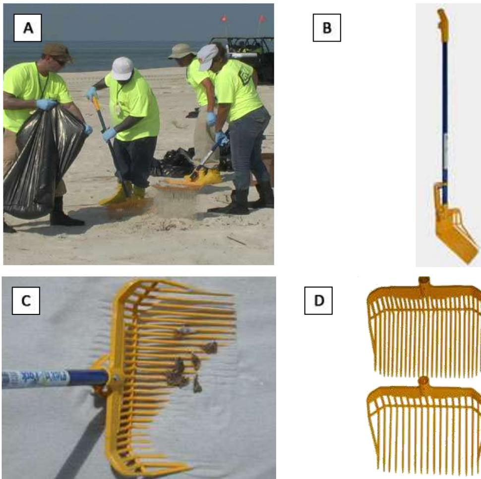
**Figura 40** – Rastrillos vibratorios marca Shake’nRake en la limpieza de playas A) Utilización de los rastrillos vibratorios en jornadas de limpieza de playa, Estados Unidos B) Rastrillo vibratorio de perfil C) Ejemplo de recolección de desechos con el rastrillo vibratorio D) Cabezal intercambiable del rastrillo vibratorio en sus dos presentaciones con diferentes tamaños de luz.
