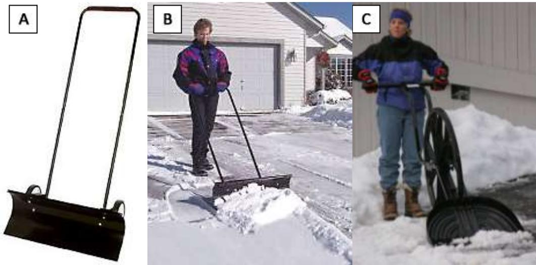
**Figura 52** – Palas quita nieve con ruedas. A y B) Pala de 2 ruedas. C) Pala de una rueda marca Wovel
