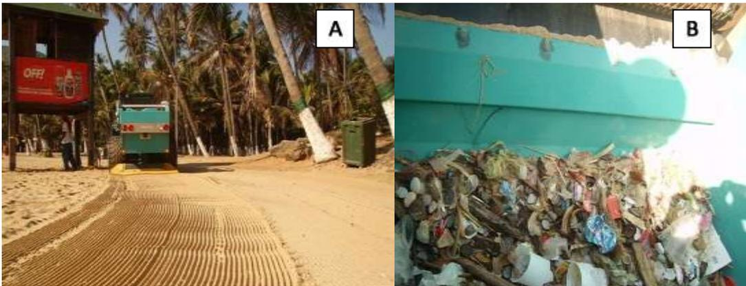
**Figura 60** – Máquina barredora de playa modelo Beach Tech Marina fabricada por la empresa alemana Kässbohrer A) Imagen del estado en el que queda la arena luego del paso de la barredora B) Interior de la tolva llena de los desechos que se recogieron en la playa. A simple vista pueden observarse vasos y envases plásticos, palos, tapas de botella, bolsas, etc.
