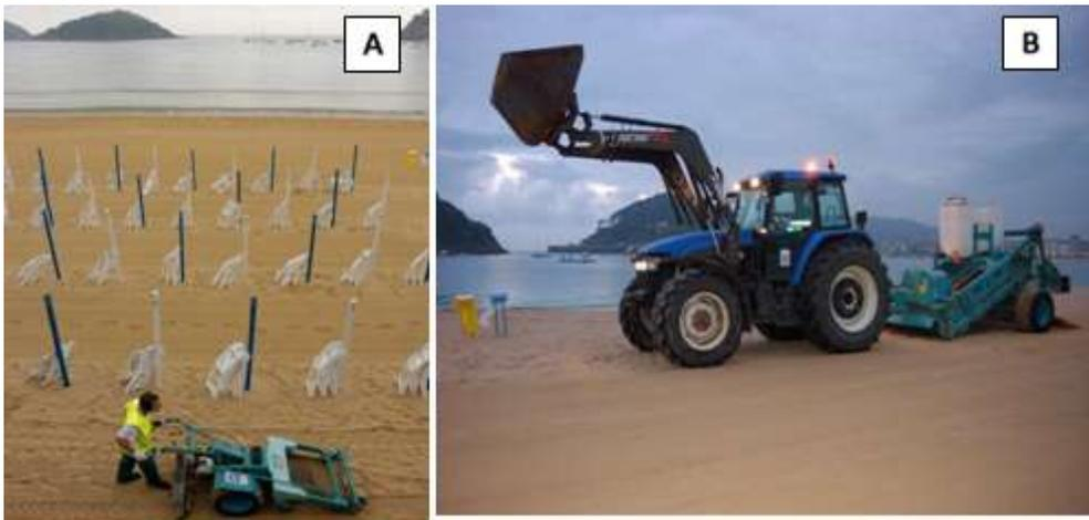
**Figura 30** – Máquinas cribadoras A) Máquina autopulsada no tripulada B) Máquina tipo remolque
